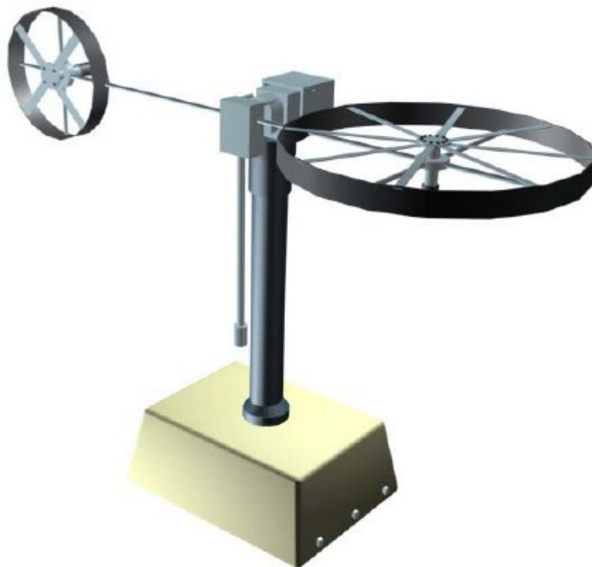
Obrázek 6 – Identifikovaný model Twin Rotor MIMO System
