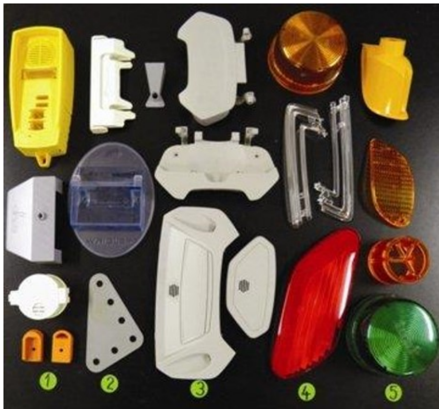
Obr. 1. Výrobky z amorfních termoplastů: 1 - styrenové polymery (PS, SB, SAN); 2 - terpolymer ABS; 3 - polymerní blend PC/ABS; 4 - polymethylmetakrylát PMMA; 5 - polykarbonáty PC [6]
