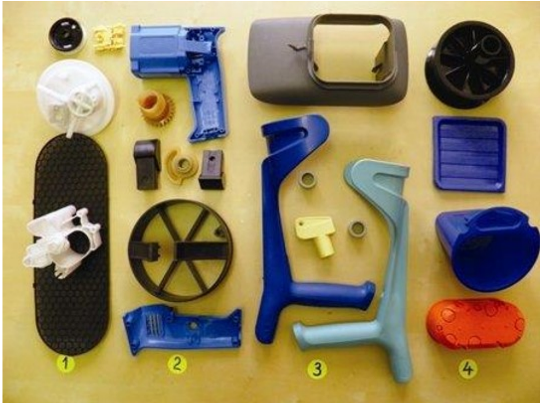
Obr. 2 Semikrystalické termoplasty: 1 – polyformaldehyd POM; 2 – polyamidy PA 6, PA 6,6; 3 – polypropylen a kopolymery PP; 4 – polyetyleny PE [6] [12]
