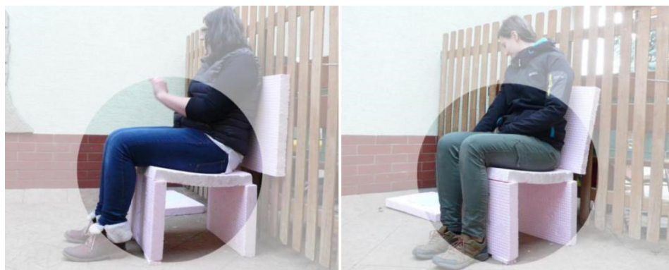
Obr. 67. a Obr. 68. Zkouška ergonomie na extrudovaném polystyrenu
