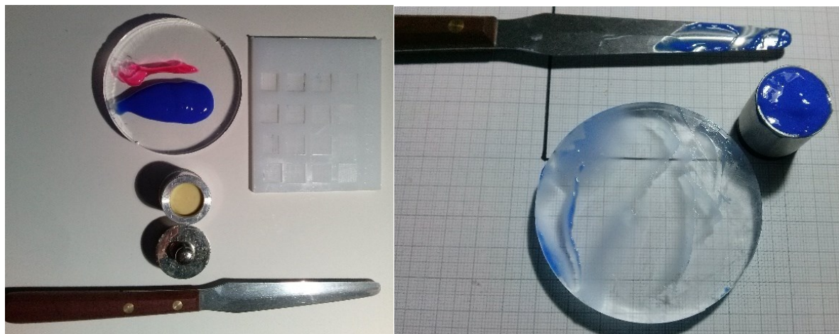
Obr. 19 Nanesení otiskovací hmoty do přípravku
