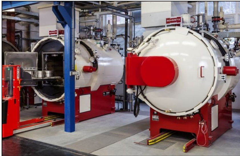
Obr. 9 - Kalicí a popouštěcí pece (Interní materiály)
