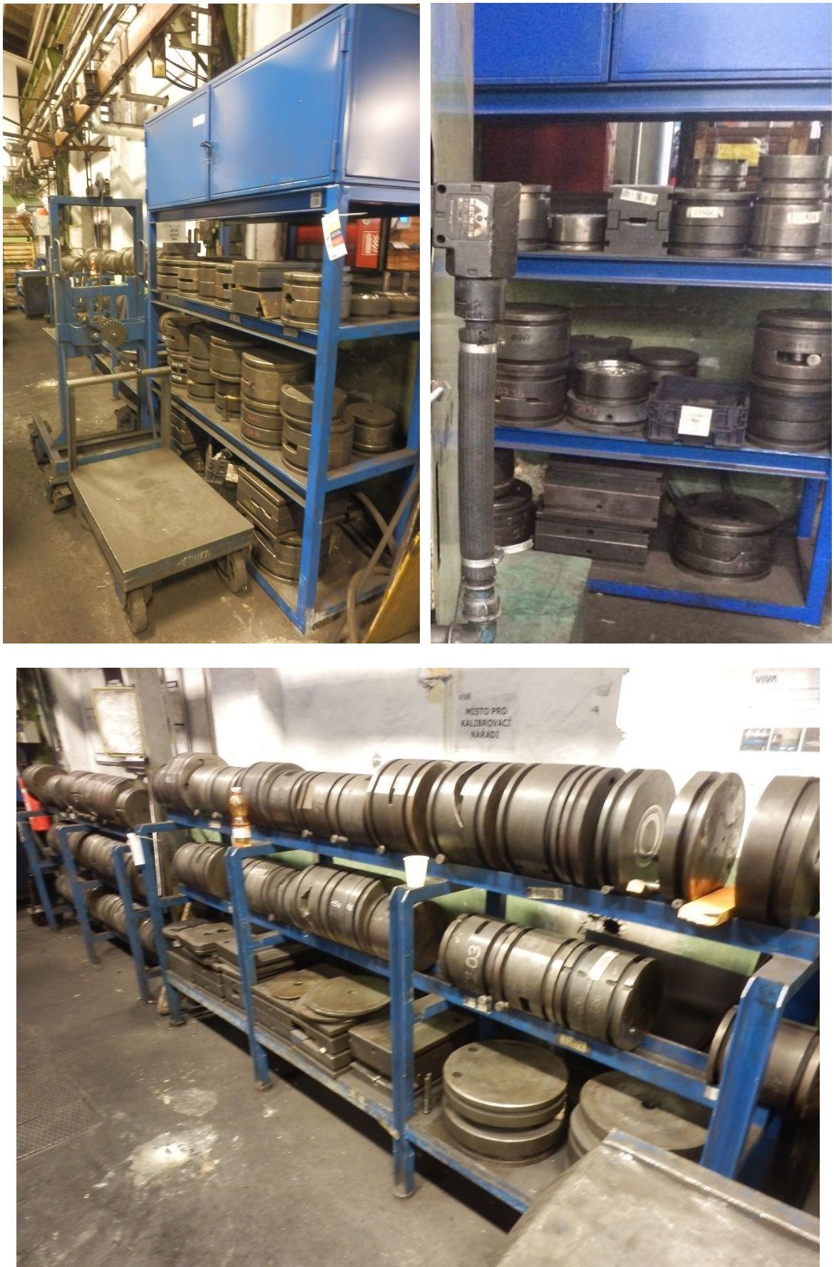
Obrázek 42: Uložení zápustek při současném stavu (interní materiály firmy)
