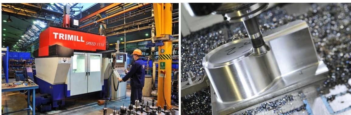
Obrázek 16: Obráběcí centrum Trimill při výrobě nástroje (interní materiály firmy)
