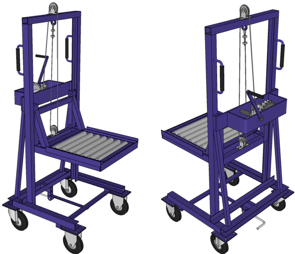
Obrázek 43: Návrh nového řešení polohovacího stolu pro pracoviště kalibrace (vlastní zpracování)
