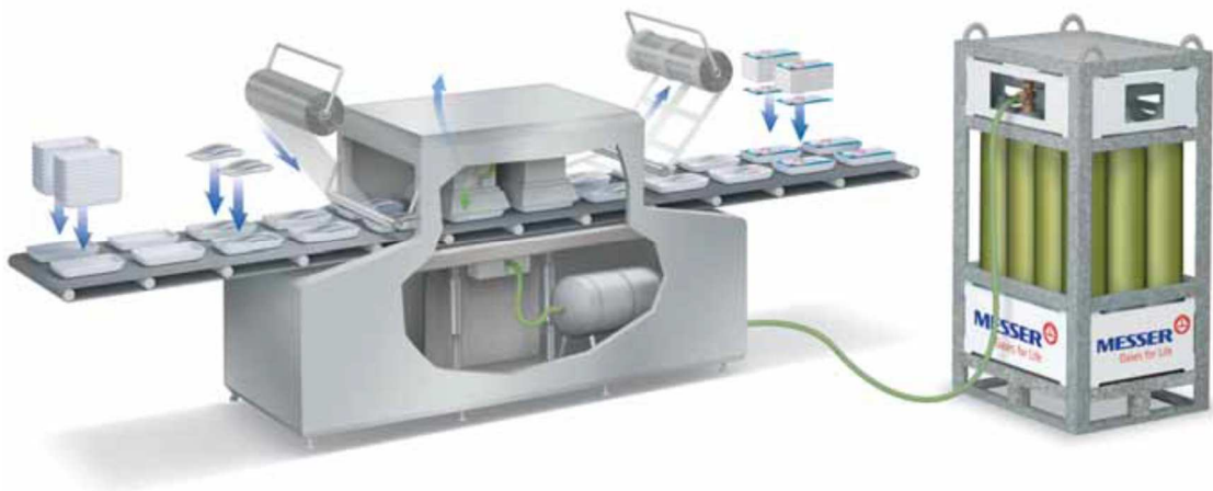
Obr.23. Aplikace modifikované atmosféry ze svazku do balicího zařízení [43]
