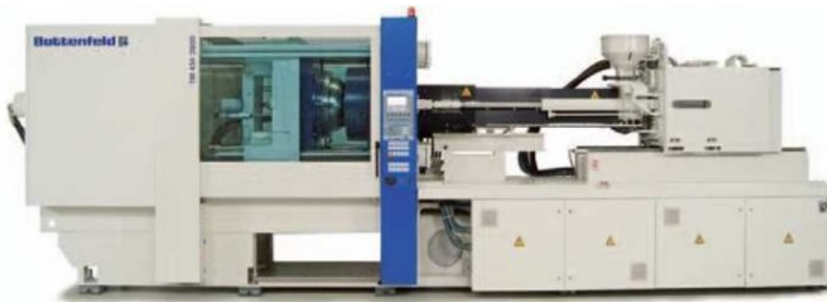
Obr. 51. Vstřikovací stroj BATTENFELD BA 1500 / 630 BK [21]
