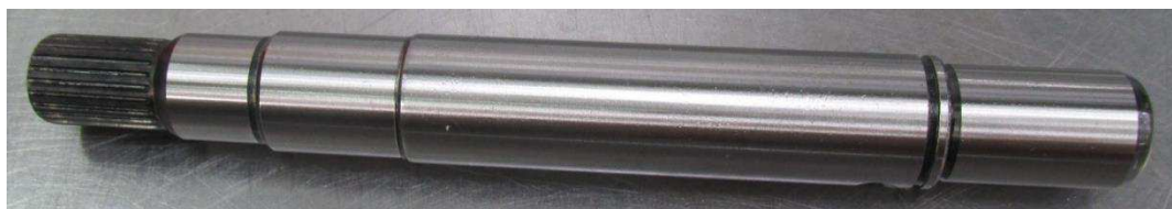
Obr. 17 Súčiastka po procese brúsenia
