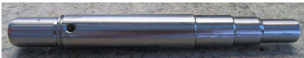
Obr. 14 Súčiastka po procese sústruženia
