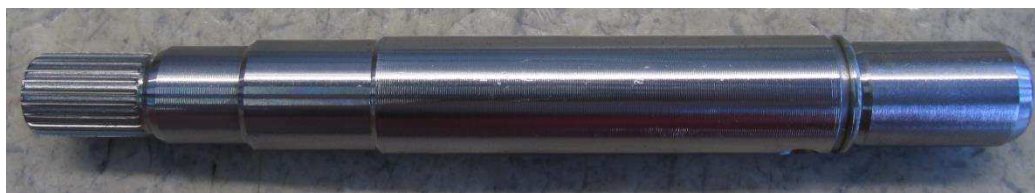
Obr. 15 Súčiastka po procese valcovania
