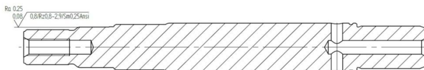
Obr. 64 Kritický rozmer Ra (0,08 – 0,25) definovaný na súčiastke Shaft Delta
