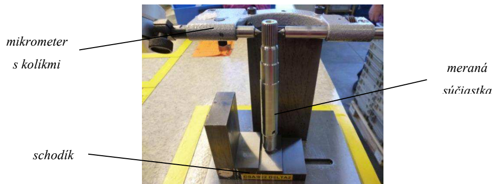
Obr. 20 Uchutenie súčiastky pri meraní daného priemeru po valcovaní a kalení
