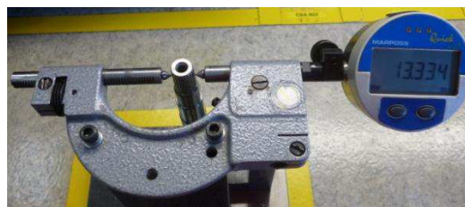
Obr. 21 Spôsob merania daného priemeru po valcovaní a kalení
