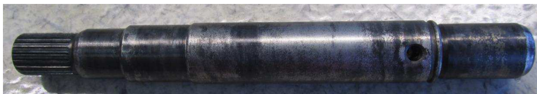
Obr. 16 Súčiastka po procese kalenia
