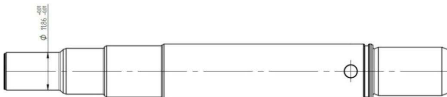
Obr. 26 Kritický rozmer D 11,86 ( \pm 0,01 ) mm definovaný na súčiastke Shaft Delta
