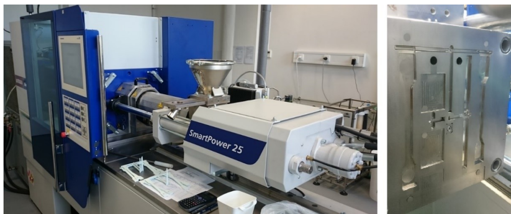
Obr. 19 Vstřikovací stroj a konstrukční řešení vícenásobné formy
