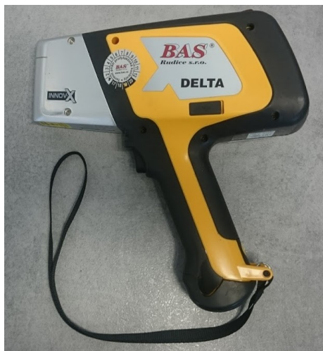
Obr. 18 Ruční analyzátor těžkých kovů BAS Delta XRF
