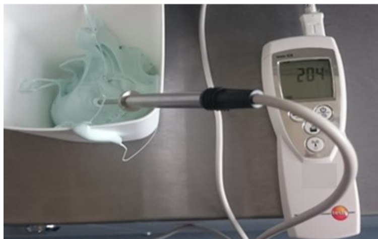
Obr. 20 Měření teploty taveniny pomocí teploměru Testo
