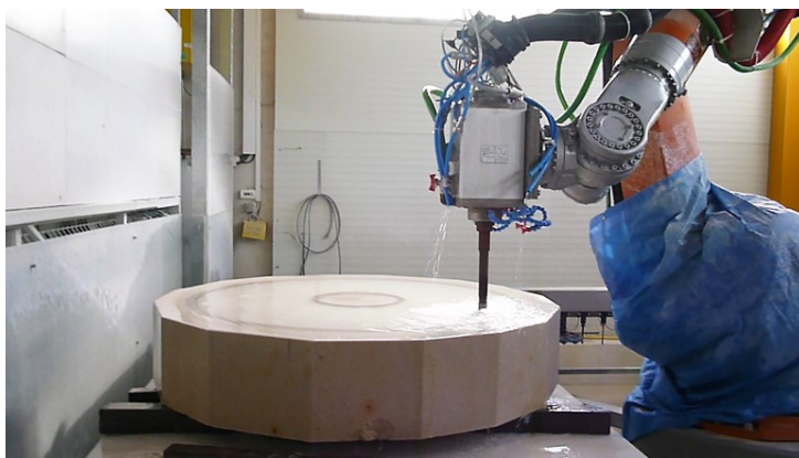
Obr. 10 Robotizované obrábění kašny Koloděje [21]
