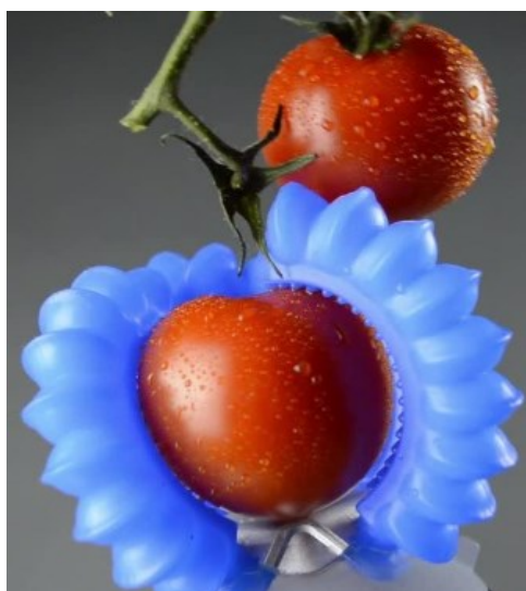
Obr. 12 Adaptivní chapadla manipulačního efektoru z pružného materiálu [23]
