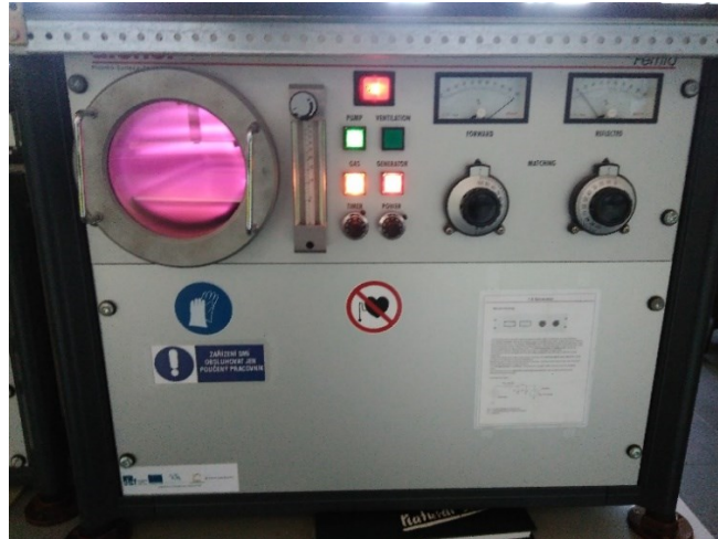
Obrázek 10. Radiofrekvenční plazmatický reaktor s kapacitním buzením, Diener Femto, 13,56 MHz
