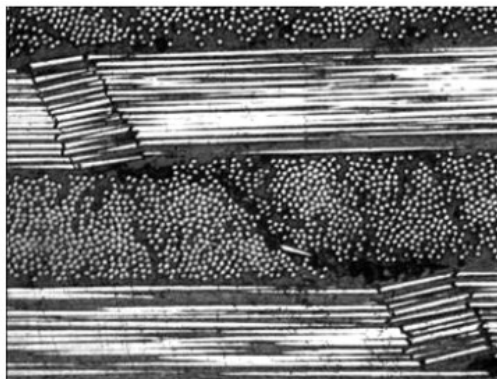
Obrázek 17 - Mikroskopické zachycení lomu vrstvy vláken [26]
