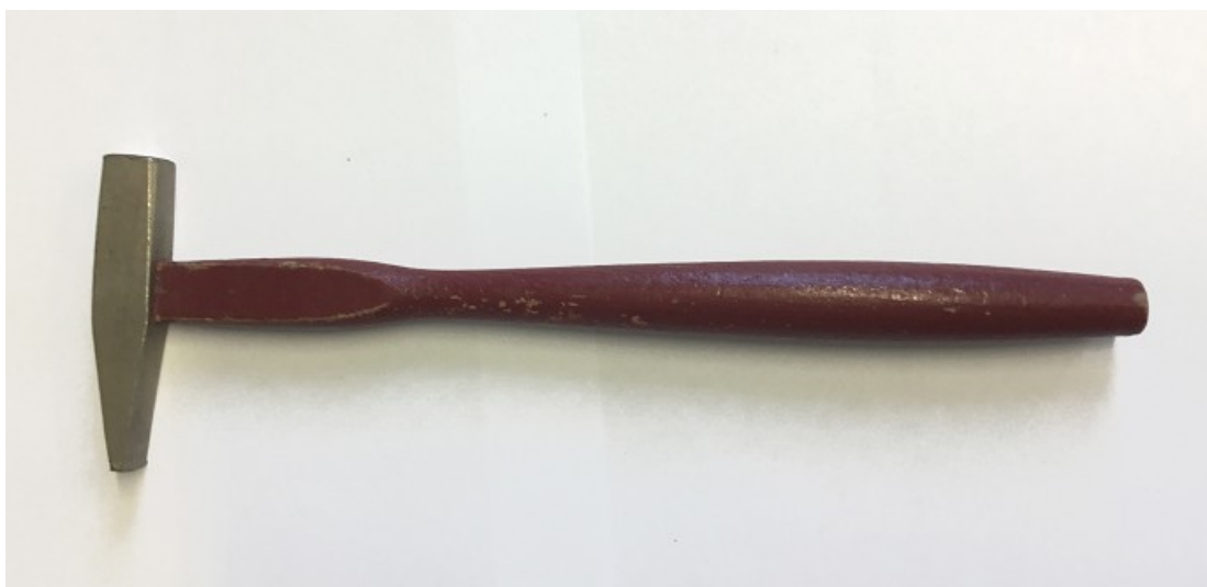
Obrázek 57 – Kladívko použité pro zkoušku poklepem
