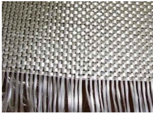
Obrázek 7 - Tkanina vyrobená ze skleněného vlákna [27]
