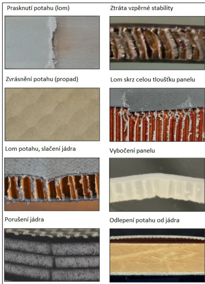
Obrázek 25 - Reálné fotografie poškození VSP v důsledku mechanického namáhání [28]
