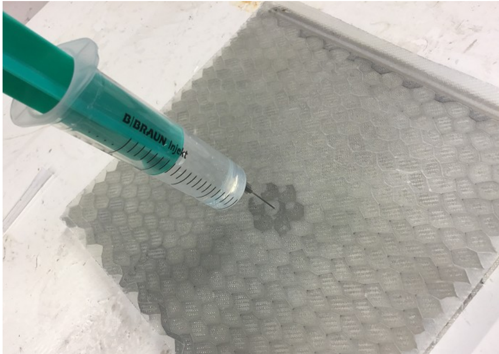
Obrázek 50 – Injektáž vody do zkušebního vzorku č. 2
