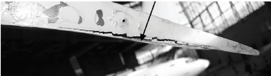
Obrázek 3 - Odlepení potahu od jádra VSP [11]
