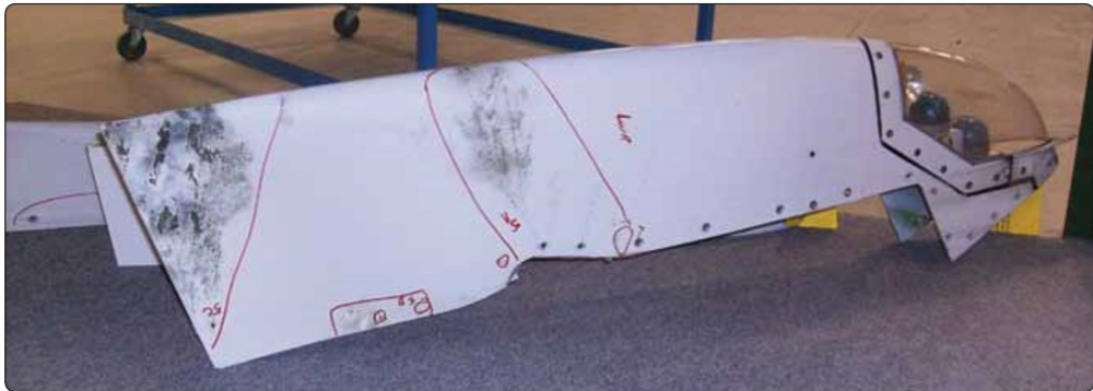
Obrázek 34 - Poškození gelcoatu sendvičové konstrukce letadla erozí [19]
