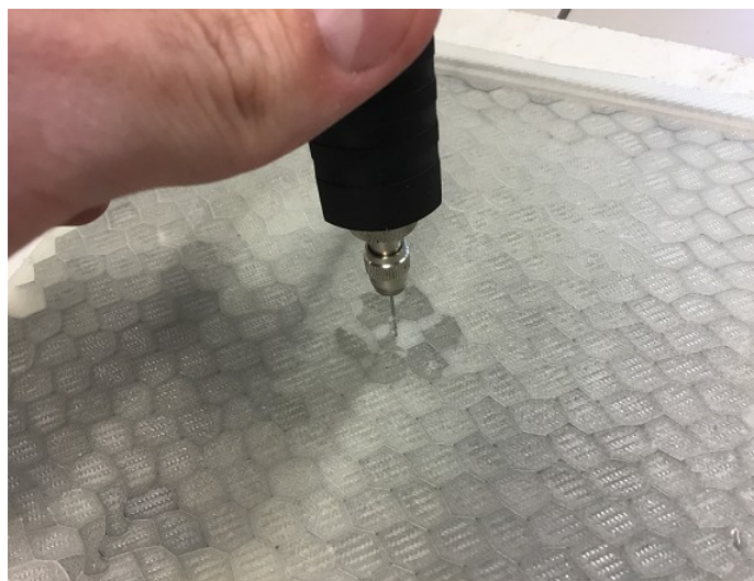
Obrázek 49 – Vrtání dírek do potahu zkušební vzorku č. 2
