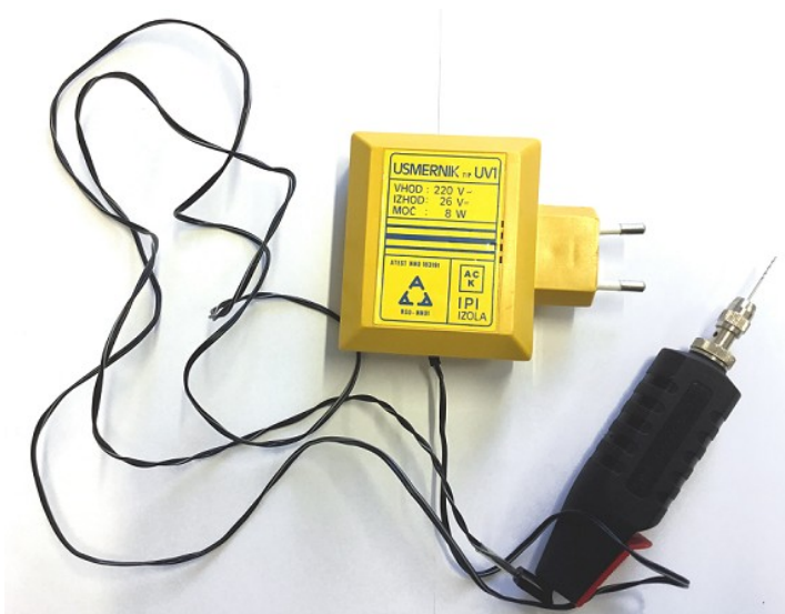
Obrázek 48 – Malá vrtačka IPI pro navrtávání potahu VSP
