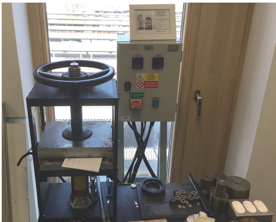
Obrázek 44 - Laboratorní vulkanizační lis
