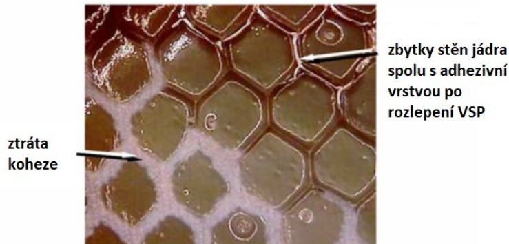
Obrázek 30 - Ztráta koheze VSP v kombinaci s roztržením jádra [26]
