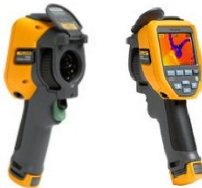
Obrázek 53 - Termokamera Fluke TiS45 [23]
