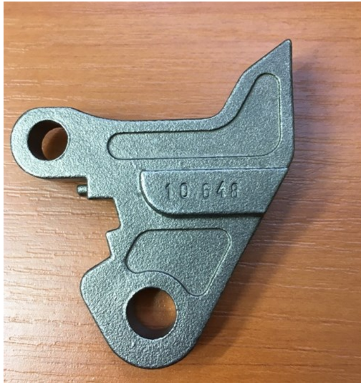
Obr. 36. Identifikace etalonu číslem odlitku (IČO)
