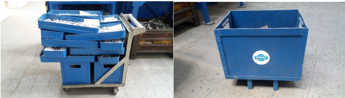
Obr. 44. Změna konstrukce beden a přepravy odlitků
