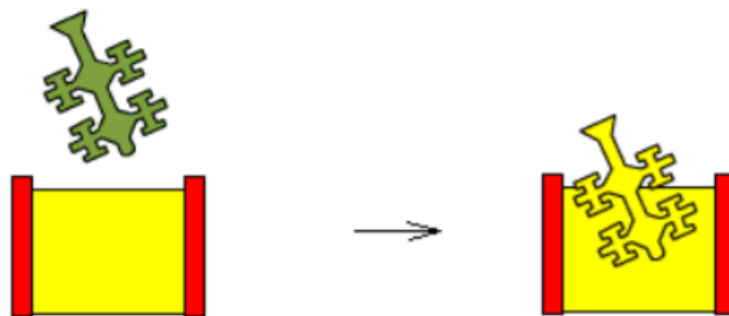
Obr. 11. Namáčení modelu do keramické břechky [7]
