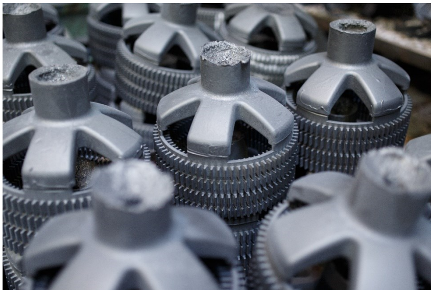
Obr. 28. Odlitek po zbavení keramiky a otryskání
