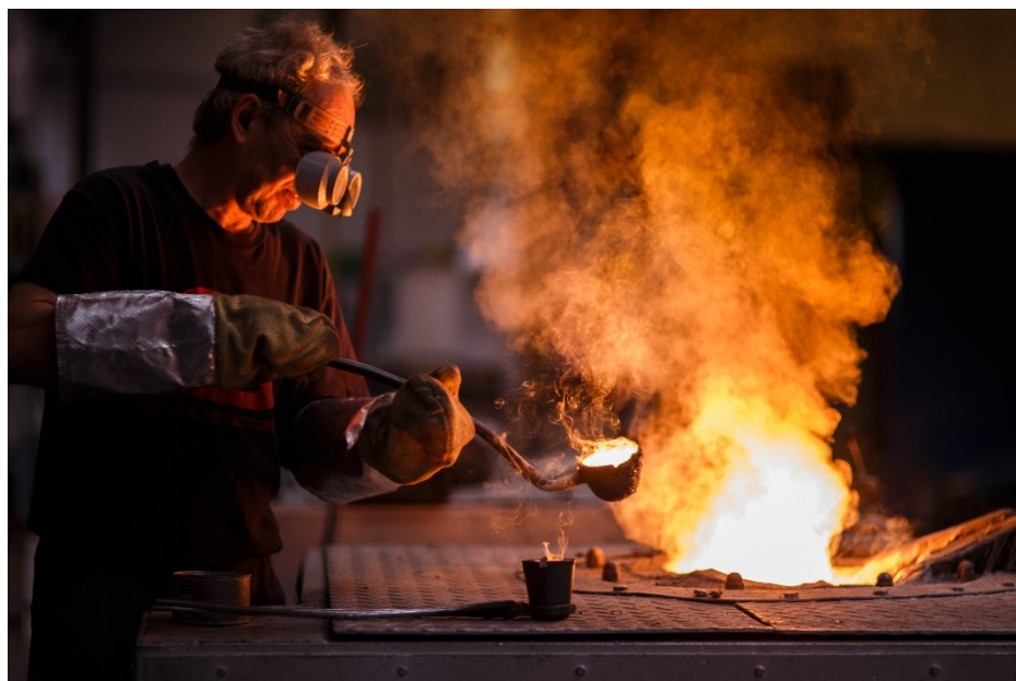
Obr. 26. Odebrání kontrolního vzorku z tavby
