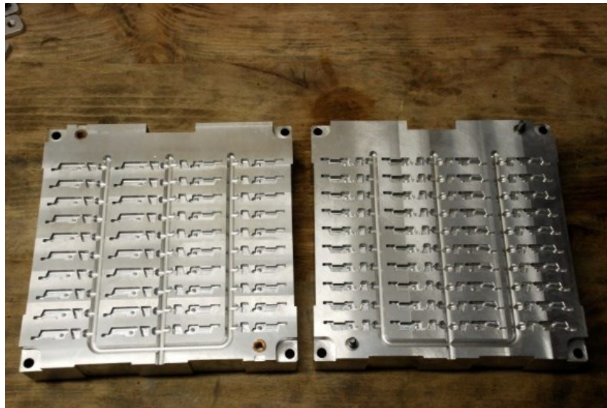
Obr. 8. Forma pro výrobu voskového modelu [17]
