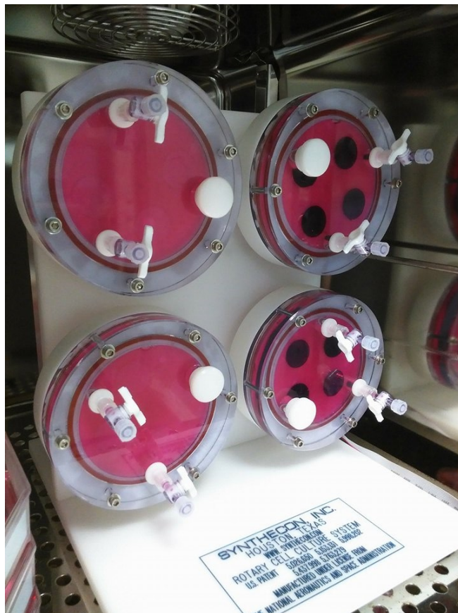
Obr. 3: Čtyř-komorový rotující stěnový bioreaktor. (zdroj fotografie vlastní)
