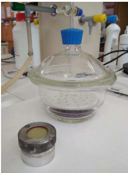
Obr. 14. Testovací kelímek s filmem a exsikator pro měření propustnosti pro vodní páry.
