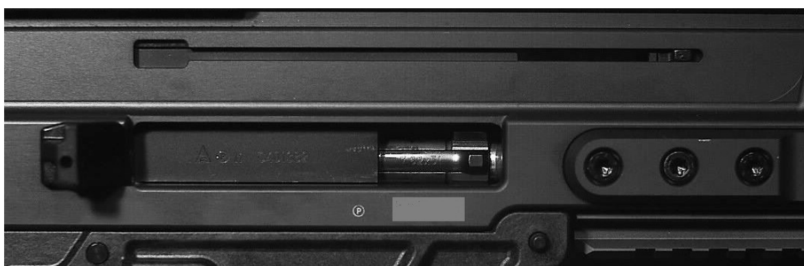
Obr. 67. Otevření závěru zbraně v době výstřelu nábojem s plastovou nábojnicí, zobrazena maximální dráha otevření.
