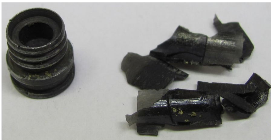
Obr. 57. Jednotlivé fragmenty nábojnice po výstřelu, kovové dno a zbytky pláště.
