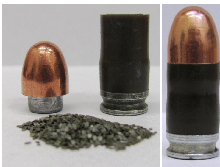
Obr. 52. Jednotlivé části náboje a kompletně vyrobený náboj ráže .45 ACP s plastovou nábojnicí a kovovým dnem upravenou z náboje 7,62 x 51 mm.
