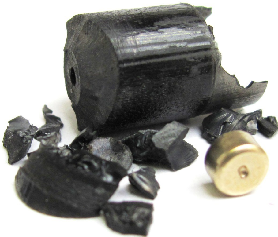
Obr. 61. Destrukce nábojnice po výstřelu - 3D tisk, zesílené vnitřní stěny.
