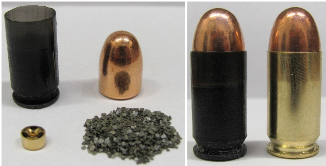
Obr. 55. Jednotlivé části náboje a vpravo porovnání složeného náboje s plastovou nábojnicí se standardním nábojem s mosaznou nábojnicí.
