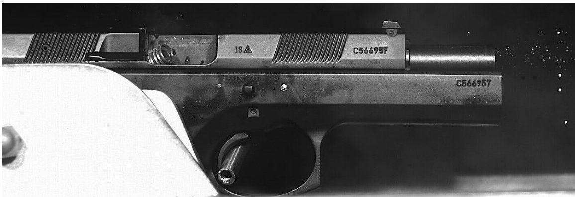
Obr. 59. Probíhající cyklus po výstřelu, kdy je zachyceno vytažení kovového dna nábojnice z nábojové komory a viditelné úlomky pláště ve výhozném prostoru závěru.
