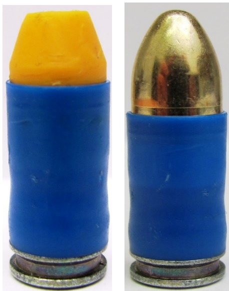
Obr. 48. Původní cvičný náboj firmy Arex ráže 9 mm Luger, vlevo a vpravo jeho modifikace osazena střelou FMJ.
