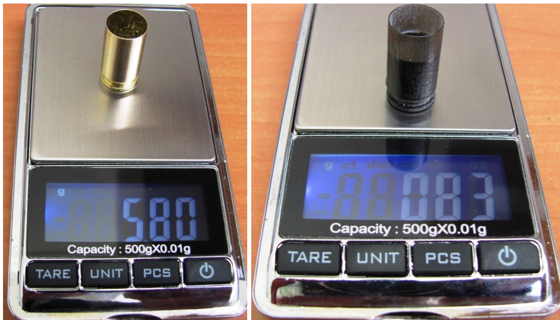
Obr. 69. Porovnání hmotností mosazné a plastové nábojnice vyrobené 3D tiskem.
