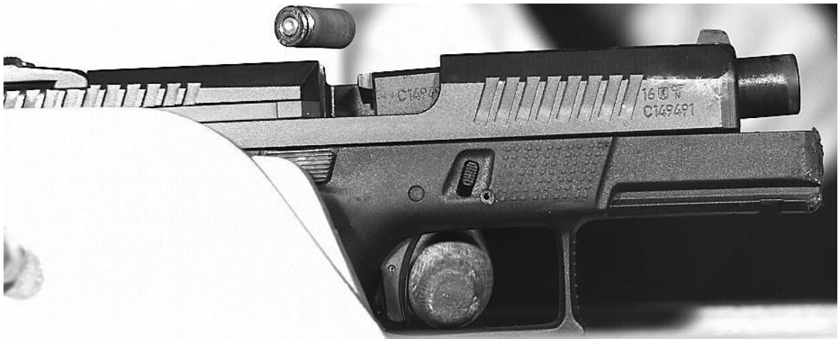
Obr. 50. Provedení vlastního výstřelu s pohledem na nábojnici, která byla vyhozena z prostoru nábojové komory mimo zbraň.
