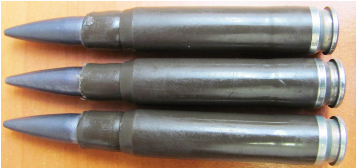
Obr. 63. Upravený náboj z původního expanzního provedení.
