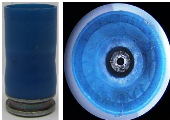
Obr. 51. Stav nábojnice po výstřelu - vlevo celkový a vpravo vnitřní pohled.
