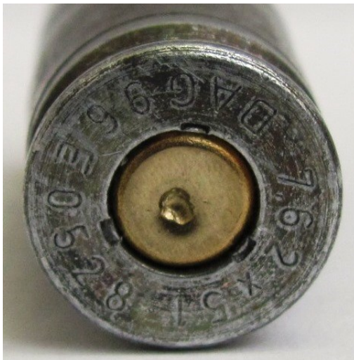
Obr. 53. Nápich zápalky náboje od zápalníku pistole, k odpálení náboje nedošlo.
