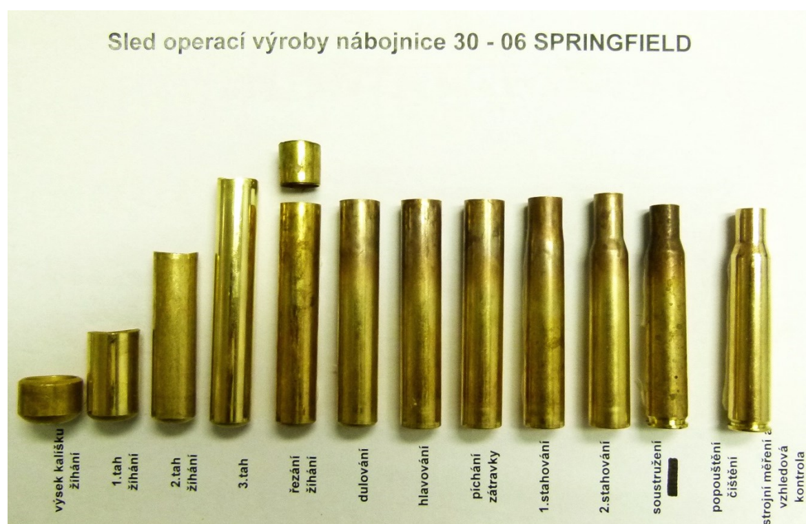
Obr. 47. Sled operací při výrobě puškové nábojnice. [8]
