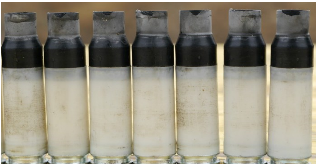
Obr. 33. Olámané ústí nábojnic PCP po výstřelu z opakovací kulovnice. [15]
