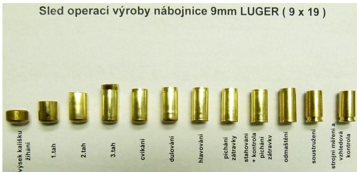
Obr. 46. Sled operací při výrobě pistolové nábojnice. [8]
