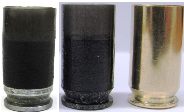
Obr. 56. Porovnání nábojnic - vlevo 3D tisk s kovovým dnem, uprostřed 3D tisk a vpravo mosaz.
