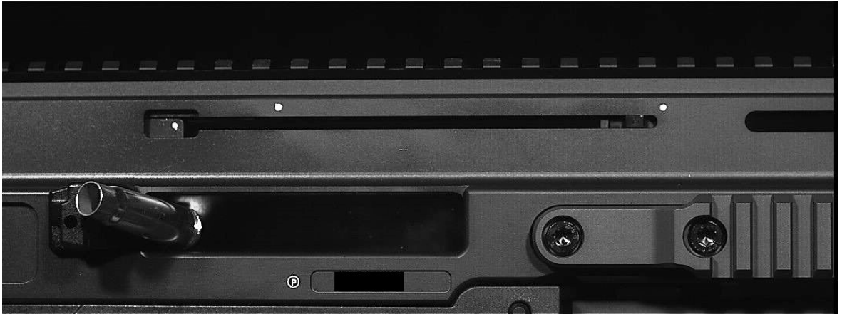
Obr. 68. Otevření závěru zbraně v době výstřelu standardním nábojem s mosaznou nábojnicí, zobrazena maximální dráha otevření.
