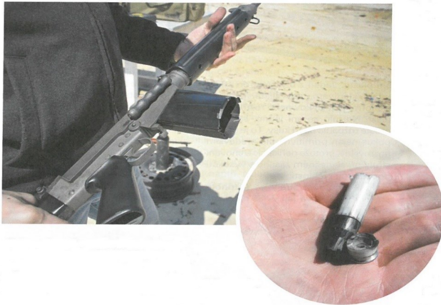
Obr. 34. Důsledek exploze nábojů v zásobníku a příčně roztržená nábojnice. [10]
