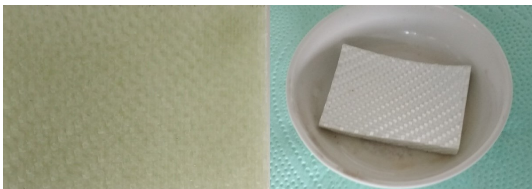
Obr. 35 Vzorek před pyrolýzou (vlevo) a po pyrolýze
