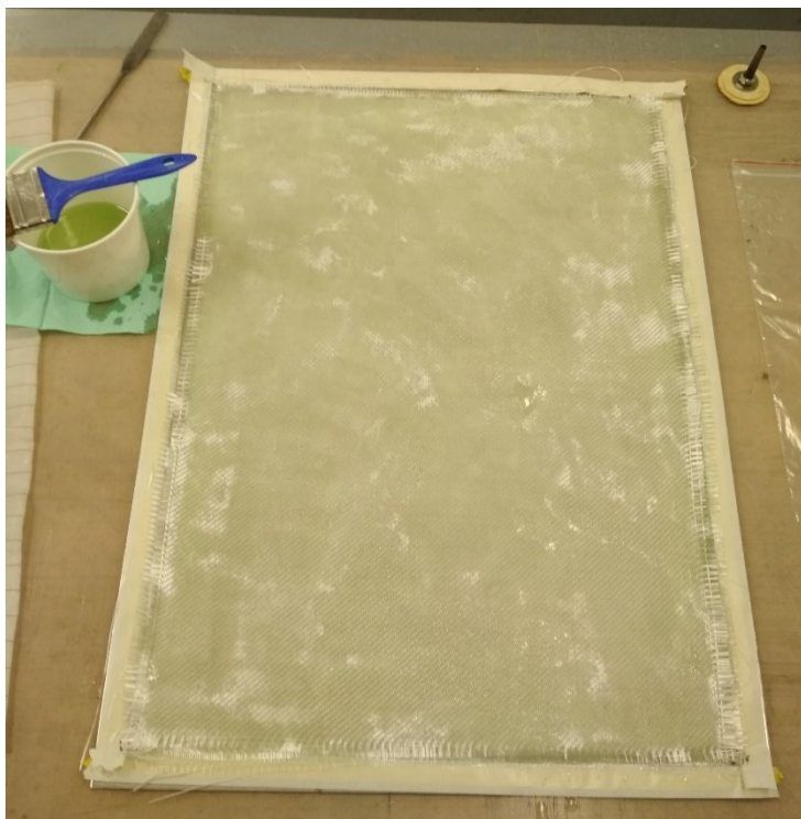
Obr. 27 Nalaminovaná nosná deska
