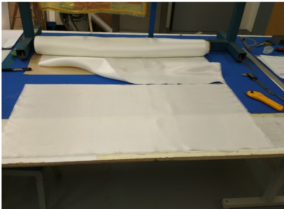
Obr. 26 Pracoviště pro řezání výztuže
