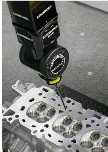
Obr. 7 Příklad použití dotykové snímací hlavy [12]
