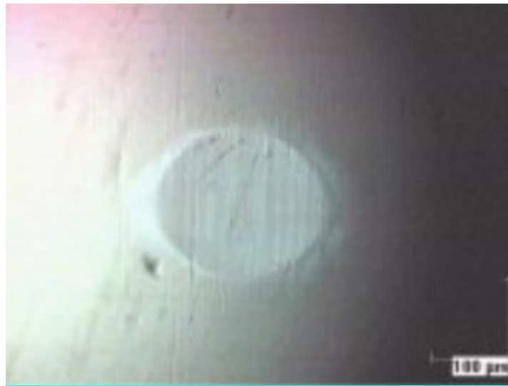
Obr. 9 Abrazivní otěr na kuličkovém dotyku [13]
