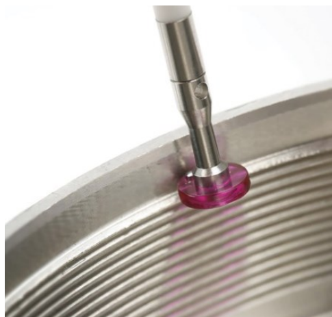
Obr. 12 Stylus tvaru disku [12]
