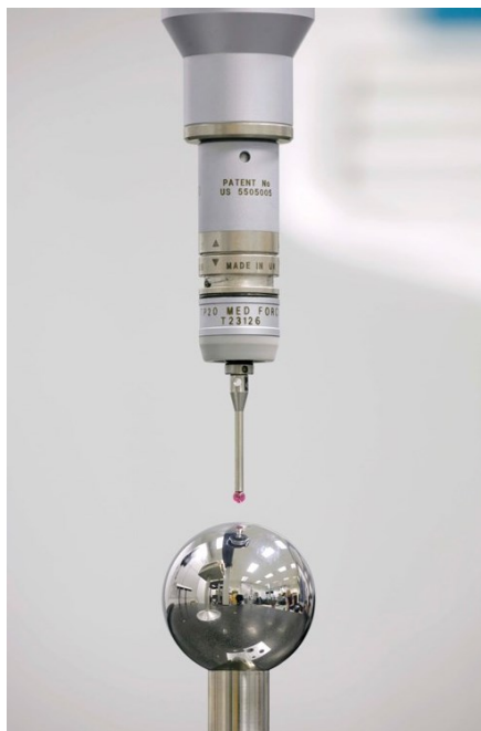
Obr. 14 Kalibrace dotykové sondy [12]
