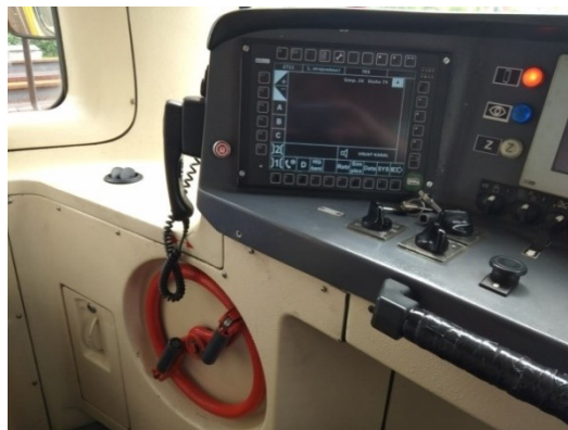
Obr. 33 Umístění mikrotelefonu radiostanice u řady 814 [zdroj vlastní]
