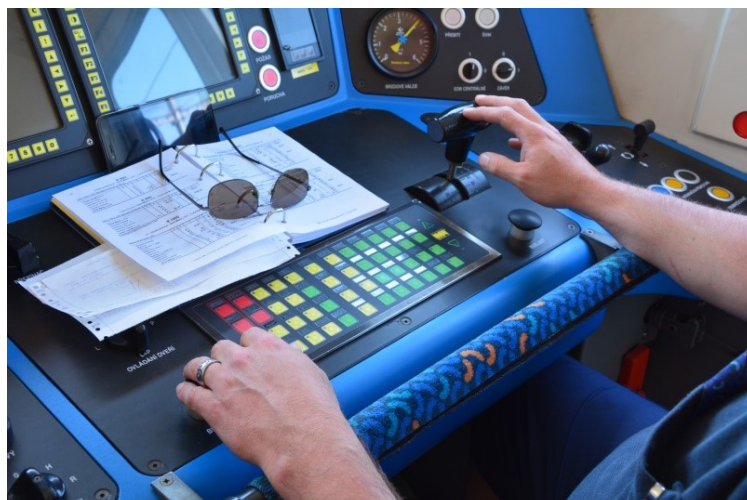
Obr. 35 Madlo na pultu u motorové lokomotivy řady 750.7, které umožňuje díky polstrování lepší komfort pro strojvedoucího [zdroj vlastní]
