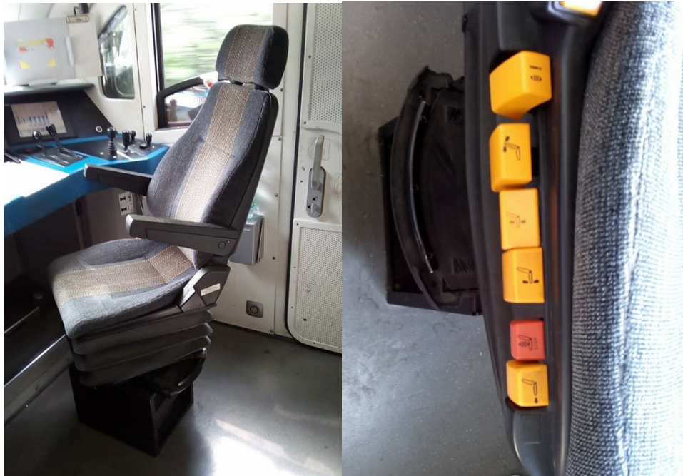
Obr. 36 Nastavitelné sedadlo z vozidla řady 1216, které je pevně spojeno s podlahou, patří mezi nejkomfortnější[zdroj vlastní]
