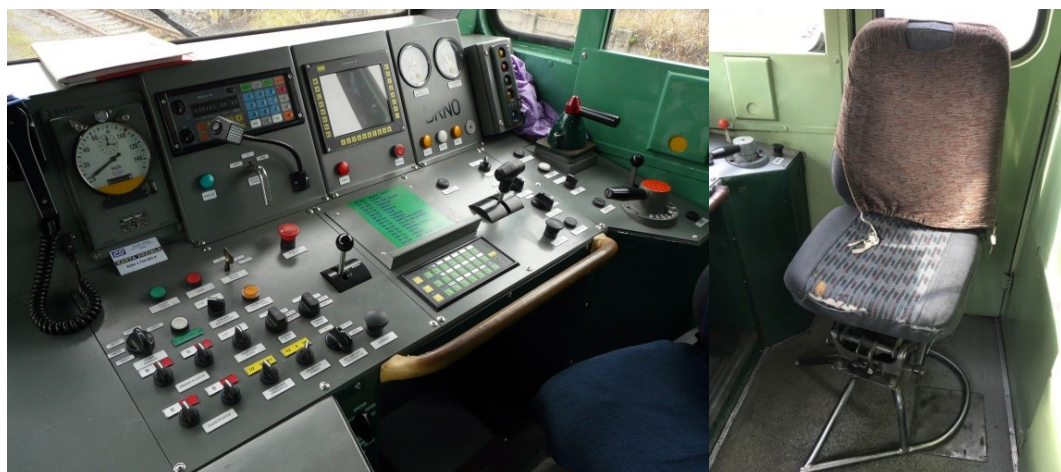
Obr. 24 Stanoviště strojvedoucího - stanoviště po modernizaci na provoz s vratnými soupravami [zdroj vlastní]
