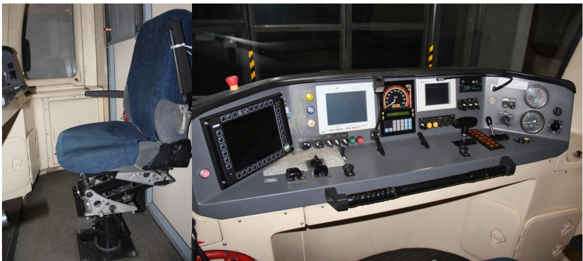
Obr. 18 Stanoviště strojvedoucího [zdroj vlastní]
