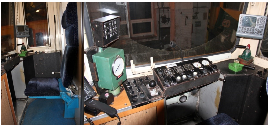
Obr. 16 Stanoviště strojvedoucího [zdroj vlastní]
