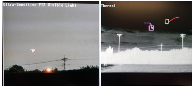
Obr. 6 - ukázka detekce v obraze viditelné spektrum/termo snímek (11)
