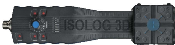
Obr. 3 - 4 směrový spektrální analyzátoř (10)
