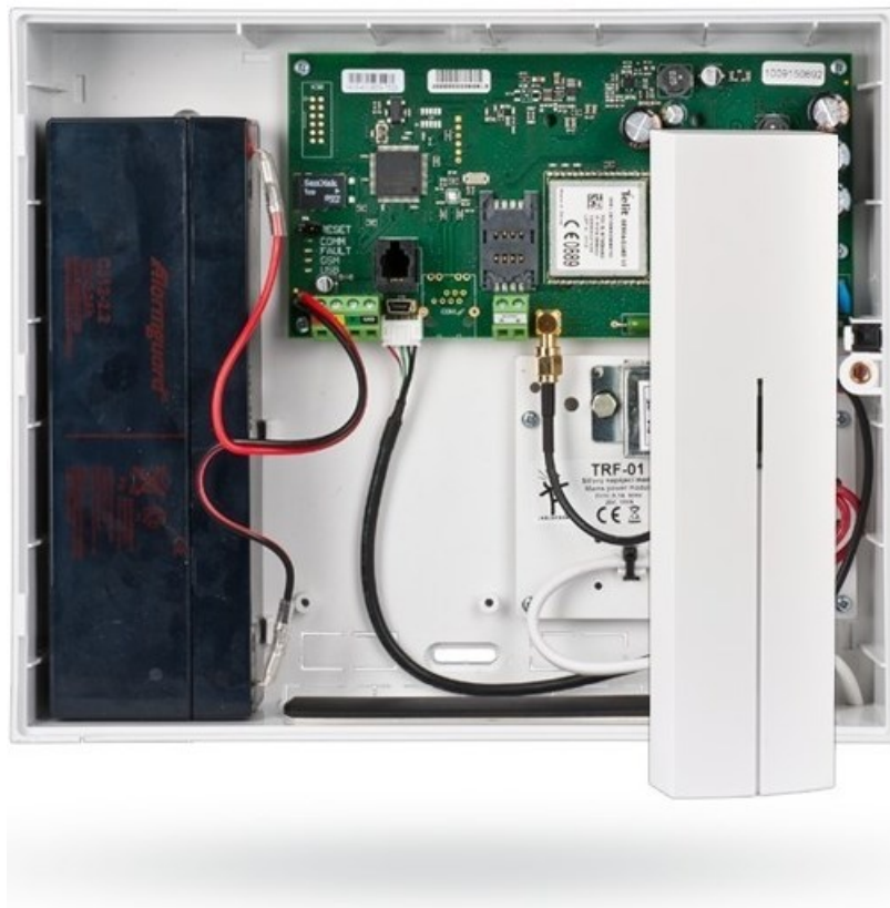
Obrázok 14: JA-101KR Ústredňa s GSM/GPRS komunikátorom a rádiovým modulom[14]
