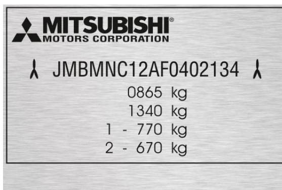
Obr. 2 Typový štítek Mitsubishi [7]
