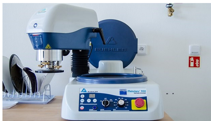
Obr. 8: Metalografická bruska a leštička [22]
