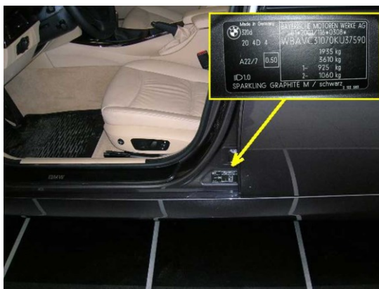
Obr. 22: Umístění výrobního štítku [32]
