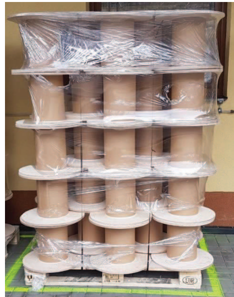
Obrázek 14 – Cívka klasik a její uložení na paletě (vlastní zpracování)
