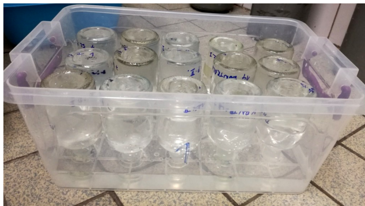
Obrázek 6: Naplněné skleněné lahvičky – kyslíkovky (dle Winklera), otočeny dnem vzhůru a připraveny k inkubaci.
