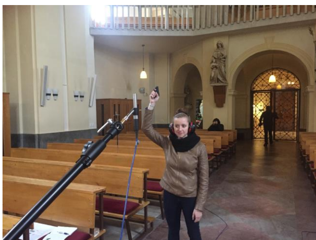
Obr. 14 Impuls k měření pomocí akustické pistole
