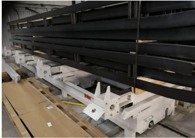
Obr. 54. Automatický řetězový dopravník s přepravními kazetami [34]
