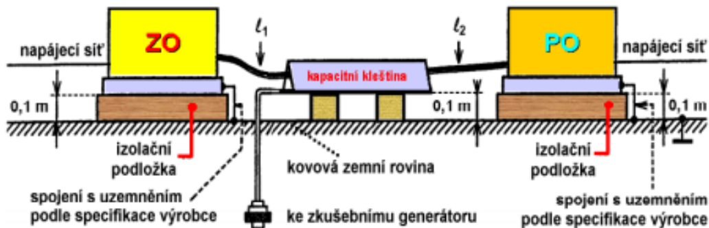
Obr. 25 Názorné uspořádání zkušebního pracoviště proti rychlým elektrickým přechodovým jevům za použití kapacitních kleští [1].
