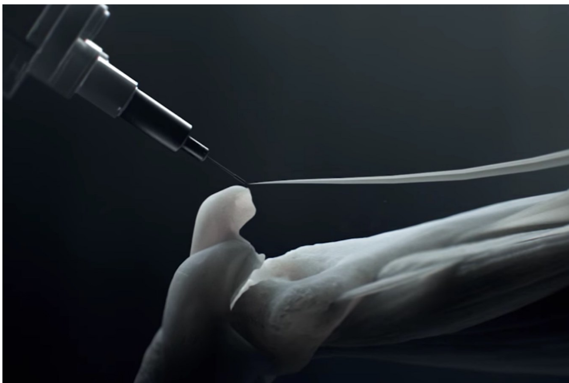
Obr. 9. Připojení 3D tištěného svalu na segment kosti
