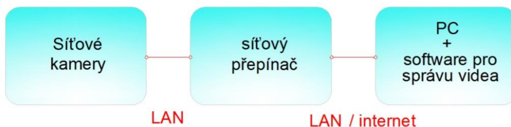
Obr. 1: Diagram síťového zapojení video systému s IP kamerami 20
