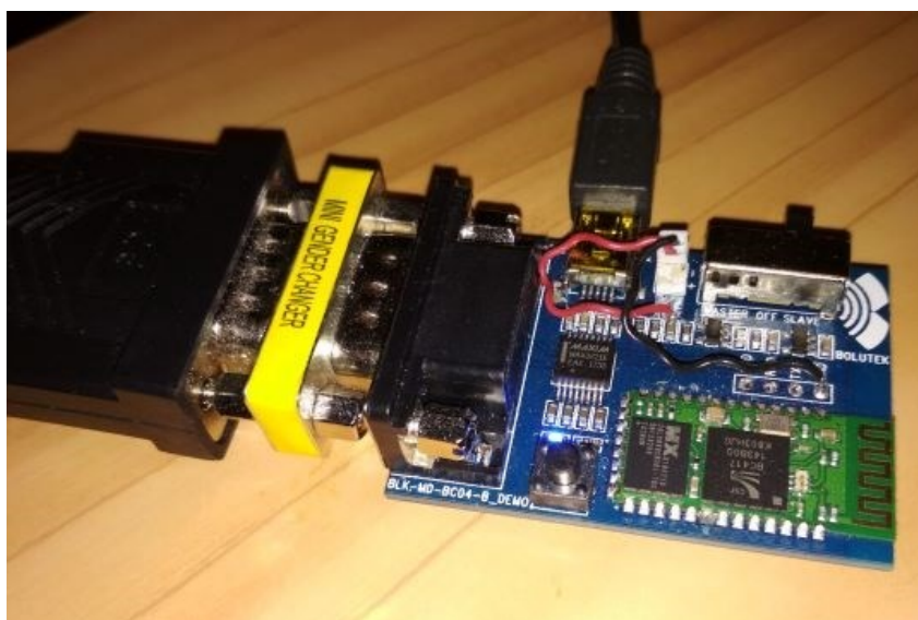
Obr. 23. Zařízení Bolutek BLK–MD-BC04-B připojené k převodníku USB to RS232.
