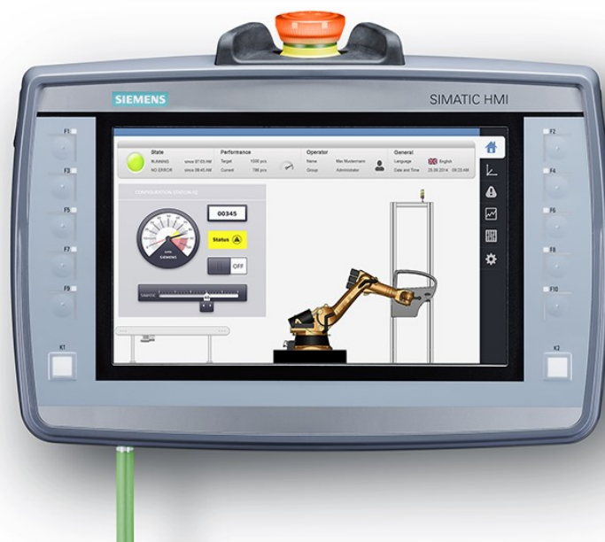
Obrázek 8 - Mobilní panel Siemens [8]
