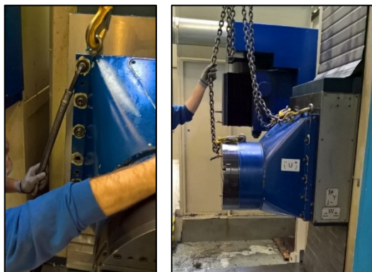
Obr. 32. Montování hlavy (foto autor)
