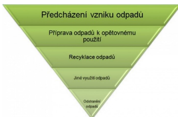
Obr. 1 Hierarchie nakládání s odpady (ČAOH prosazuje co nejširší možnosti nakládání s odpady, ©2012).
