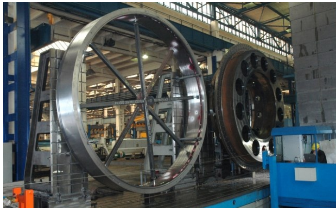
Obrázek 11 Součást vrtací soupravy pro vrtání tunelů metra (Slovácké strojírny, © 2019)
