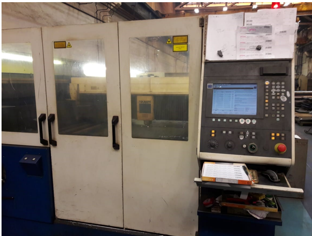
Obrázek 24 Současný pálicí stroj Trumatic L 3060 (Vlastní zpracování)
