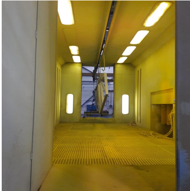
Obrázek 22 Lakování výrobku za pomoci práškové barvy (Vlastní zpracování)
