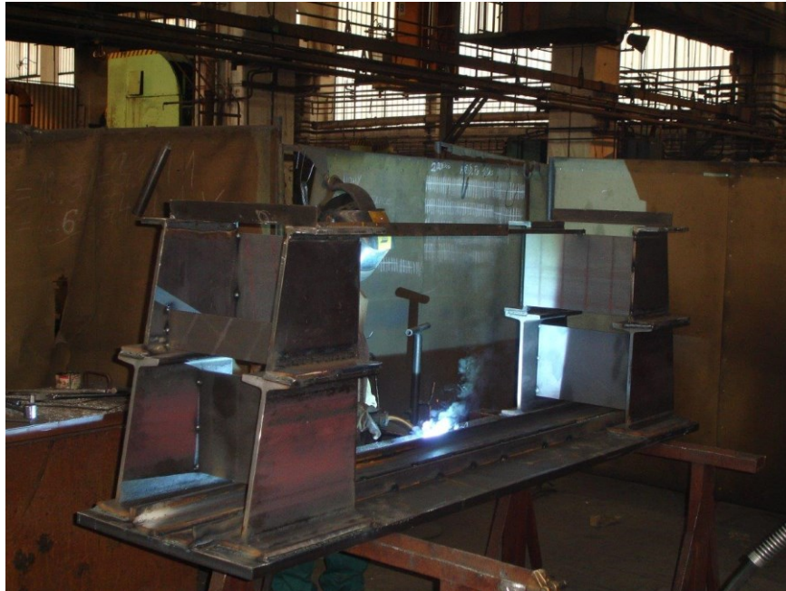
Obrázek 21 Svařování přepravní konzoly (Interní materiály firmy)
