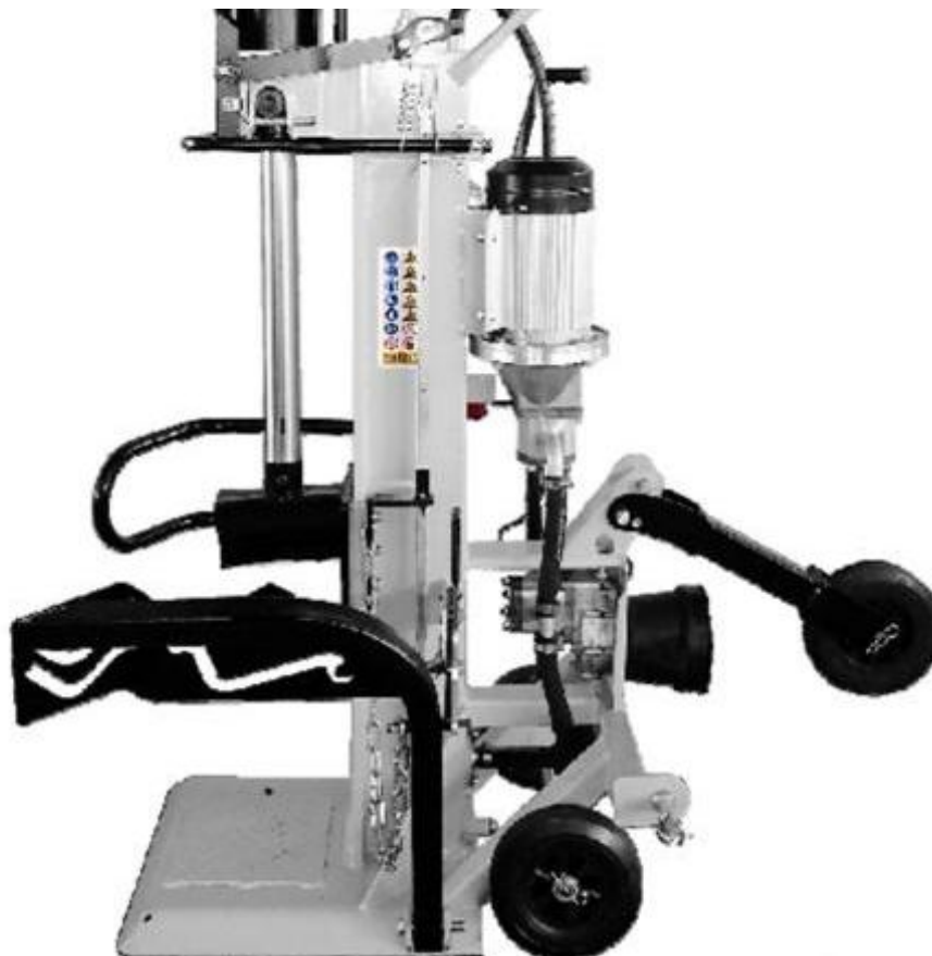
Obr. 34. Kombinace pohonu elektromotorem s pohonem vývodovou hřídelí traktoru [36]
