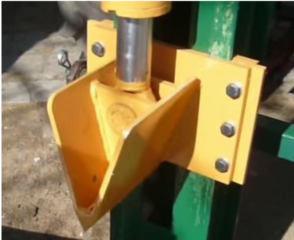
Obr. 39. Jednobřítý široký štípací klín [39, 28]
