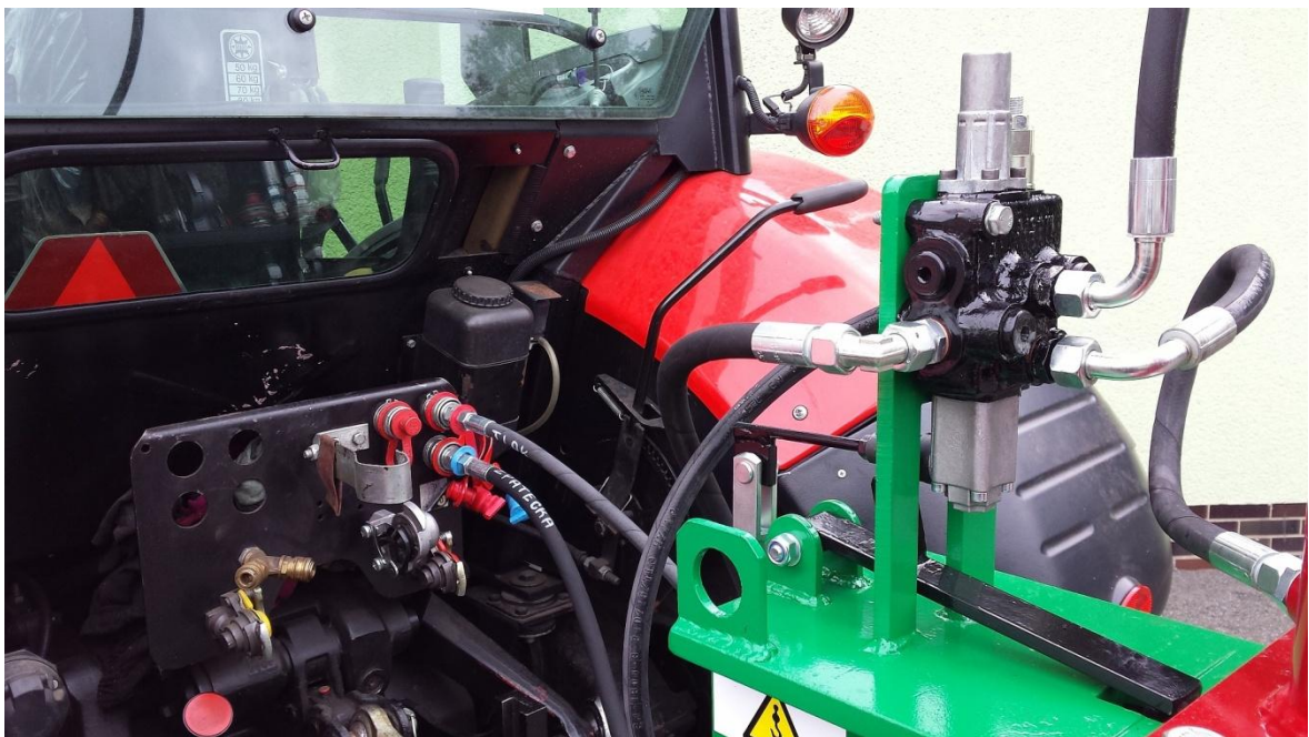
Obr. 33. Připojení štípače pomocí rychlospojek k hydraulickému okruhu traktoru [35]
