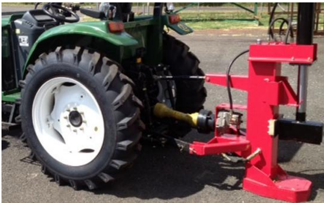
Obr. 32. Pohon hydrogenerátoru štípače vývodovou hřídelí traktoru [34]
