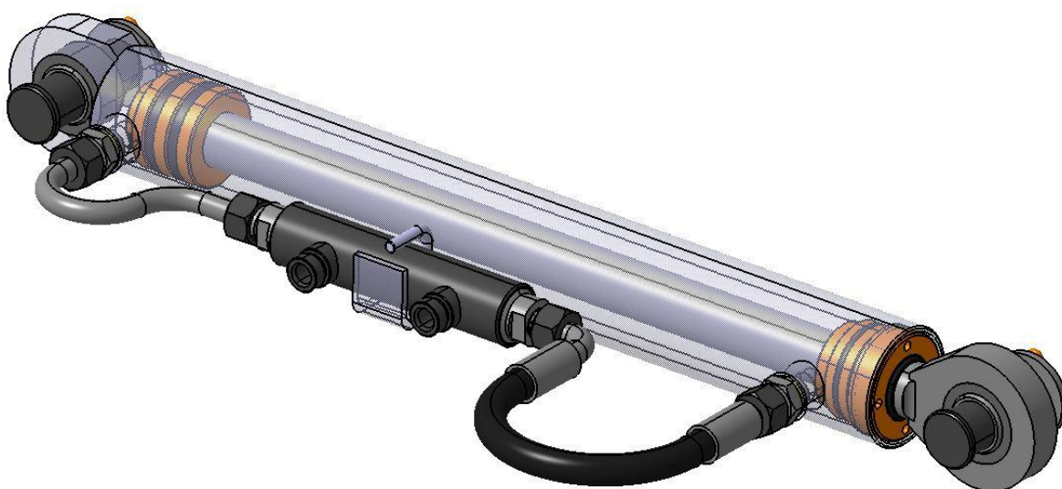
Obr. 74. Upevnění hydraulického zámku VZD10 na hydromotor zvedacího stolu
