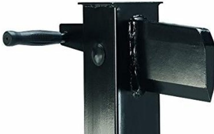
Obr. 38. Jednobřítý úzký štípací klín [28]
