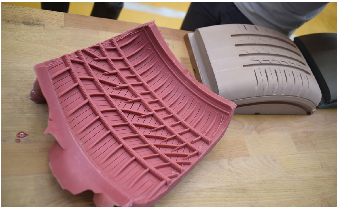
Obr. 16. Kaučuková forma „Flex“ odlitá z modelu pneumatiky [17]
