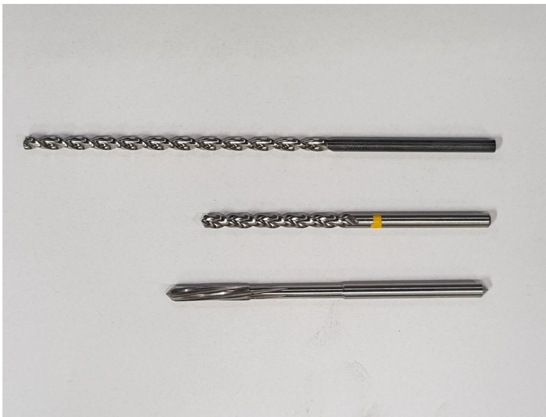
Obr. 42. Nástroje pro výrobu děr určených pro pružinové odvzdušňovací ventily.
