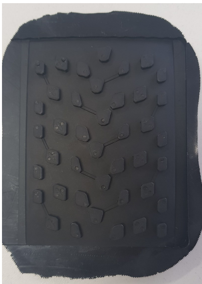
Obr. 50. Detail odlisovaného dezénu pneumatiky
