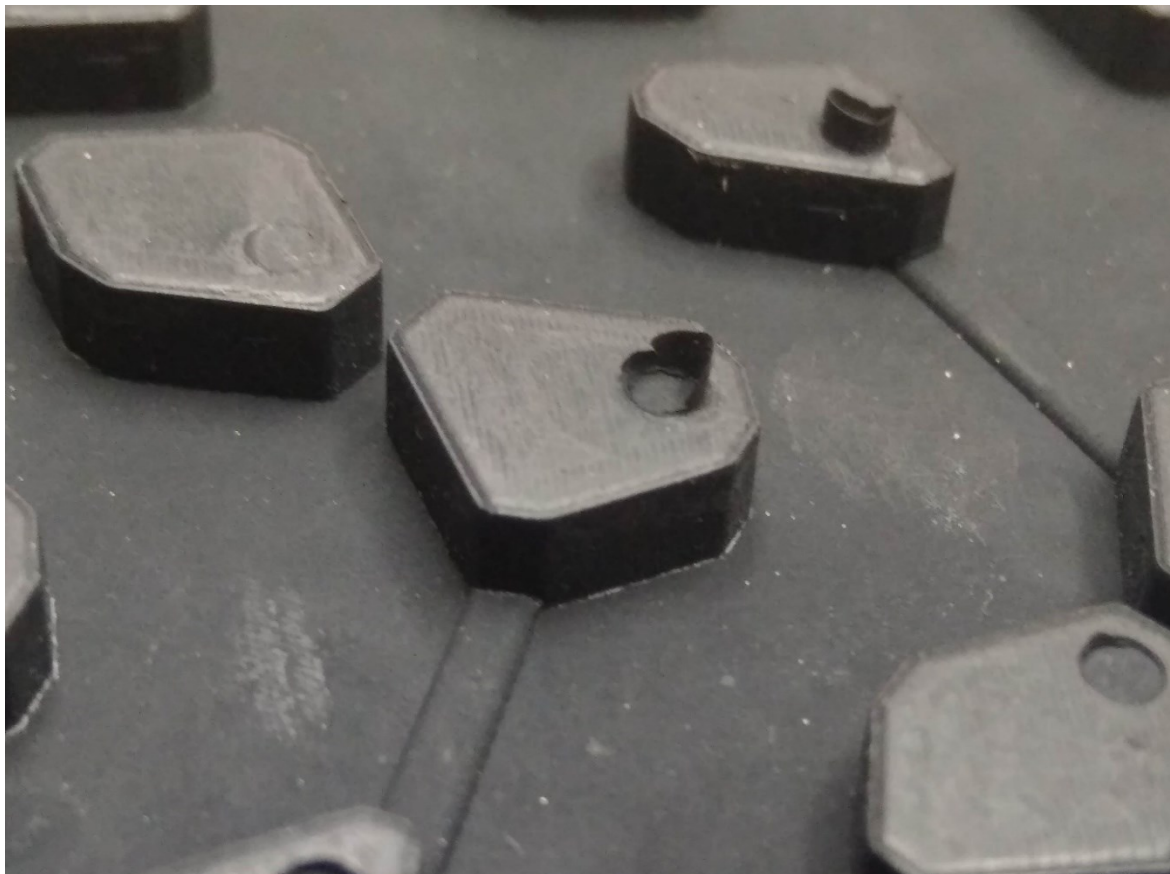
Obr. 29. Výsledky prvních lisovaných vzorků se běžným jednodílným ventilem
