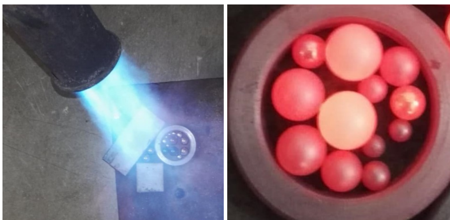
Obrázek 27 Zahřátí plynovým hořákem a následné chlazení na vzduchu
