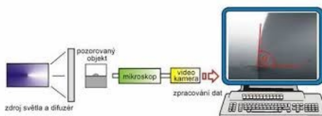
Obrázek 11 Snímání profilu kapky digitálním zařízením [15]
