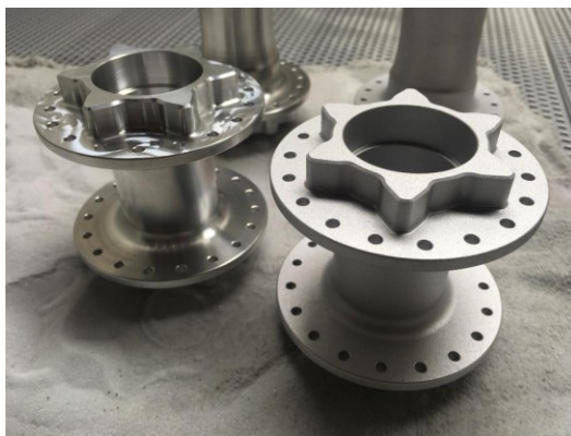
Obr.2. Vzhled balotinovaného a nebalotinovaného dílu vyrobeného ze slitiny hliníku
