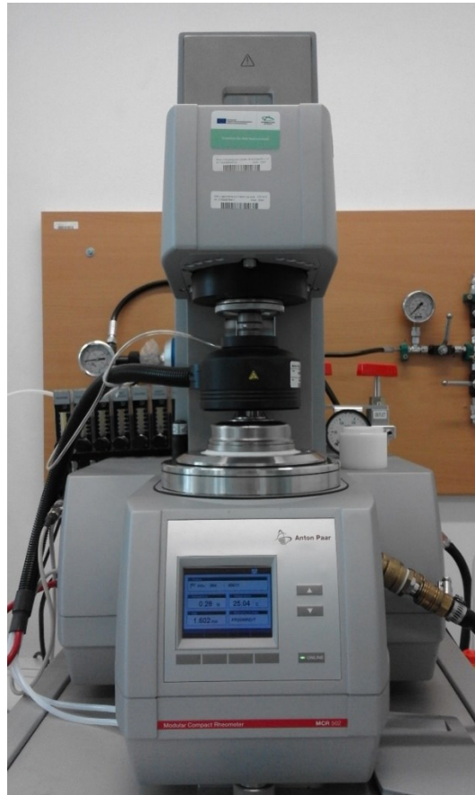
Obr. 33 Reometr Physica MCR 502 s řídicí jednotkou teploty TC 30 a topnou komorou CTD 600
