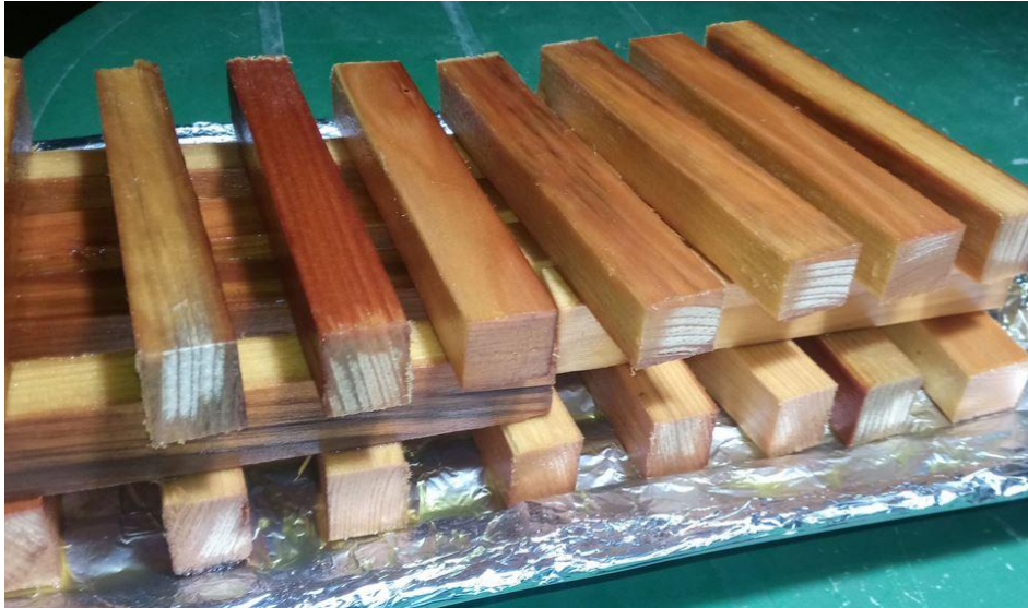
Obrázek 22 Pouze napuštěné vzorky smrku před vypečením
