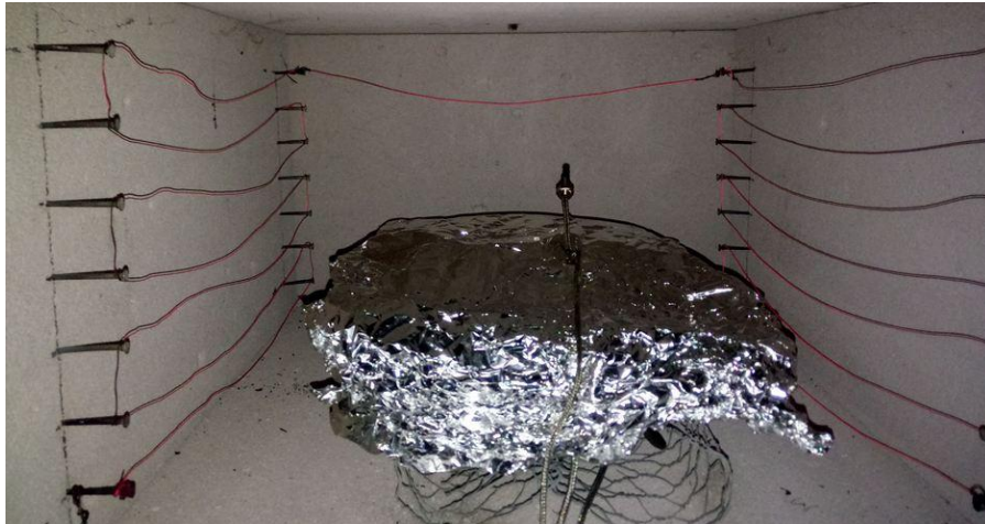
Obrázek 16 Odporová pec s regulací teploty V1.3 P \pm 1200W s balíkem dřeva
