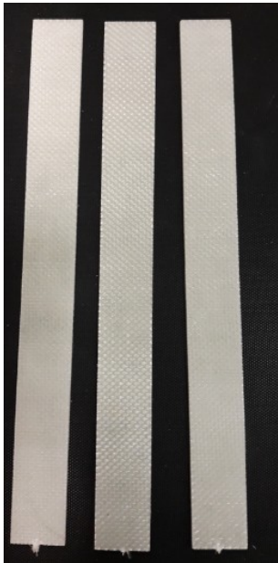
Obrázek 33 Zkušební tělesa vyrobené vakuovou infuzí
