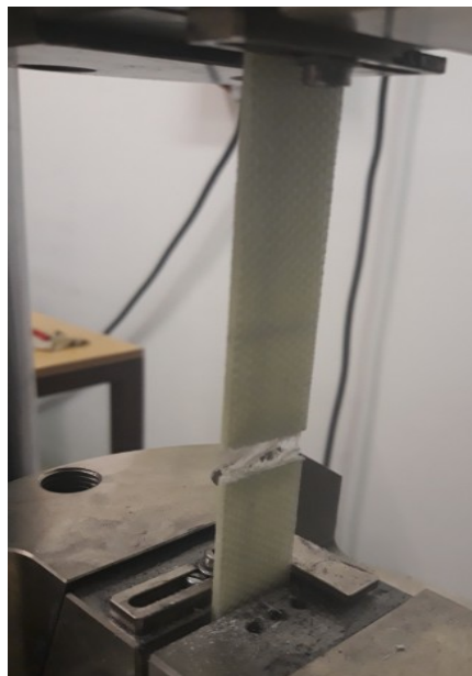
Obrázek 52 Zkušební těleso ze skleněné tkaniny po dynamické zkoušce
