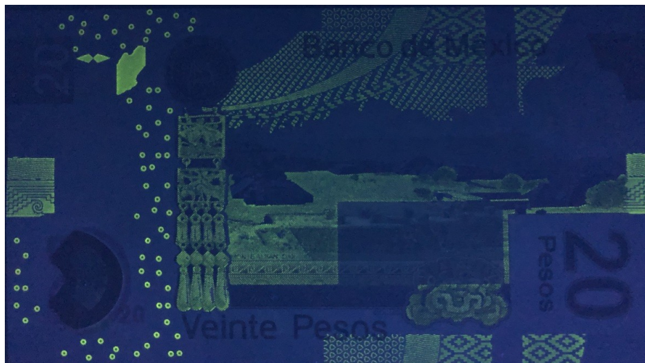
Obr. 7.17 Luminiscence pod UV světlem, \lambda = 254 \text{ nm} ; 20 MXN; 2010; reverz
