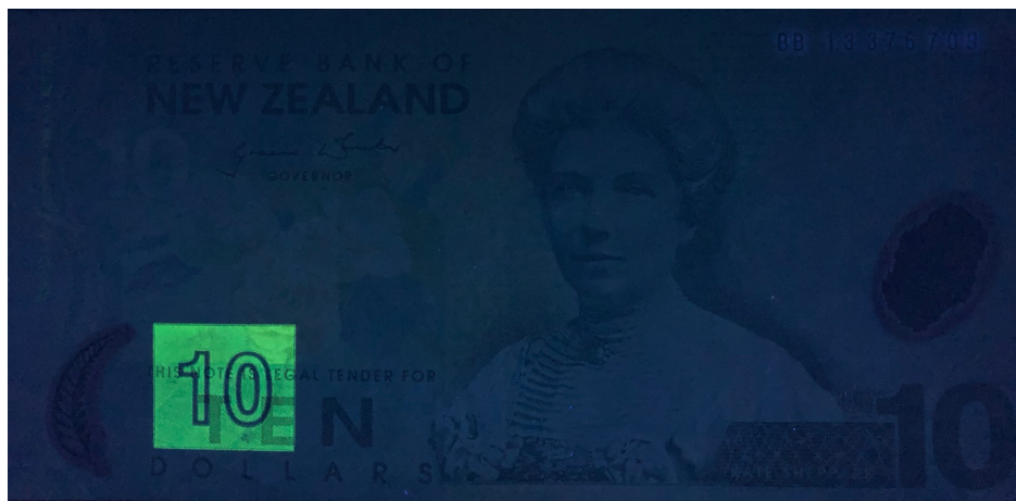
Obr. 7.6 Luminiscence pod UV světlem, \lambda = 254\text{ nm} ; 10 NZD; 2013; averz
