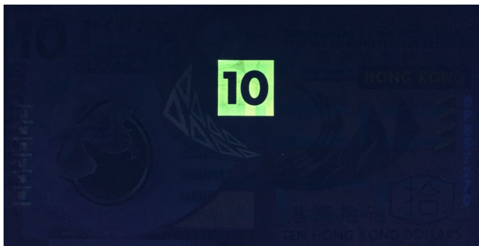
Obr. 7.24 Luminiscence pod UV světlem, \lambda = 254 \text{ nm} ; 10 HKD; 2007; averz
