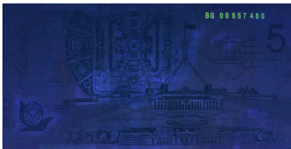
Obr. 7.4 Luminescence pod UV světlem, \lambda = 254 \text{ nm} ; 5 AUD; 2006; reverz
