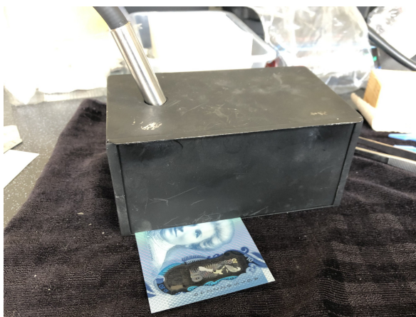
Obr. 7.3 Uzavíratelná schránka se svazky optických vláken zapojených do spektrofotometru PC1
