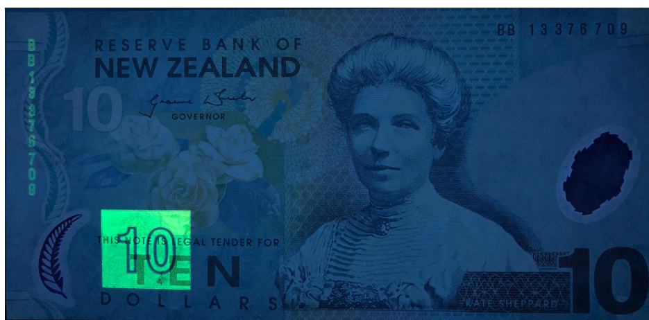
Obr. 7.7 Luminiscence pod UV světlem, \lambda = 366\text{ nm} ; 10 NZD; 2013; averz
