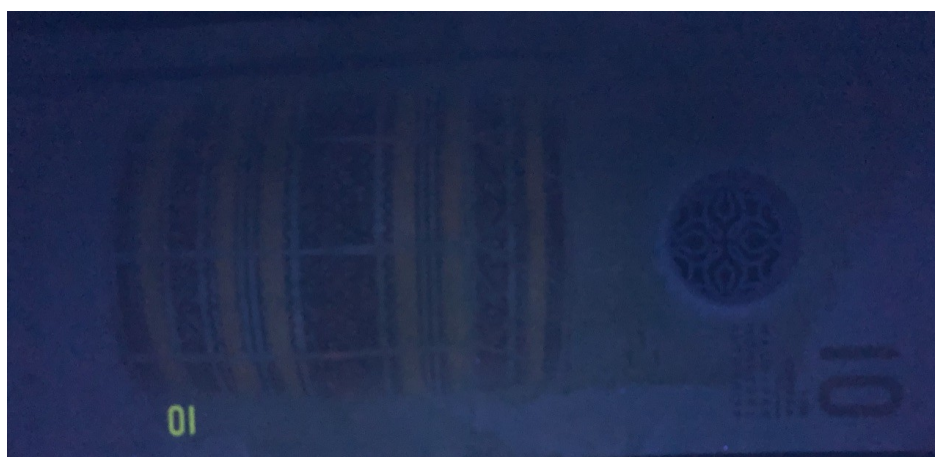
Obr. 7.20 Luminiscence pod UV světlem, \lambda = 254\text{nm} ; 10 MVR; ND(2016-2019); reverz
