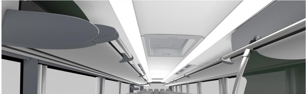
Obrázek 9 Pultruzní profily jako zavazadlové koše v autobusech
