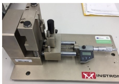
Obrázek 42 Přístroj na vyražení vrubu do zkušebního tělíska
