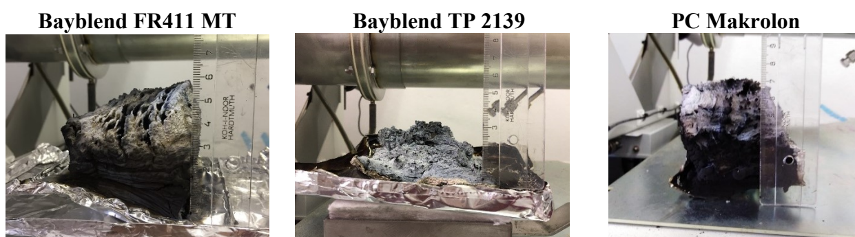
Obrázek 52 Zkarbonizované polykarbonátové vzorky
