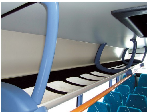
Obrázek 18 Ukázka podpůrné konstrukce pultruzních profilů v interiéru autobusů
