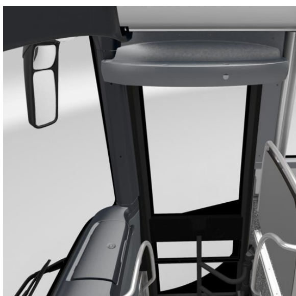
Obrázek 13 Boční kryt z ABS/PC podél čelního skla v prostoru dveří v autobusu
