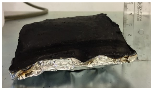
Obrázek 57 Zkarbonizované PUR vzorky
