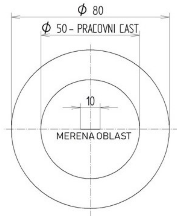
Obrázek 18 – Zkušební tělísko pro zkoušku dvousé napjatosti
