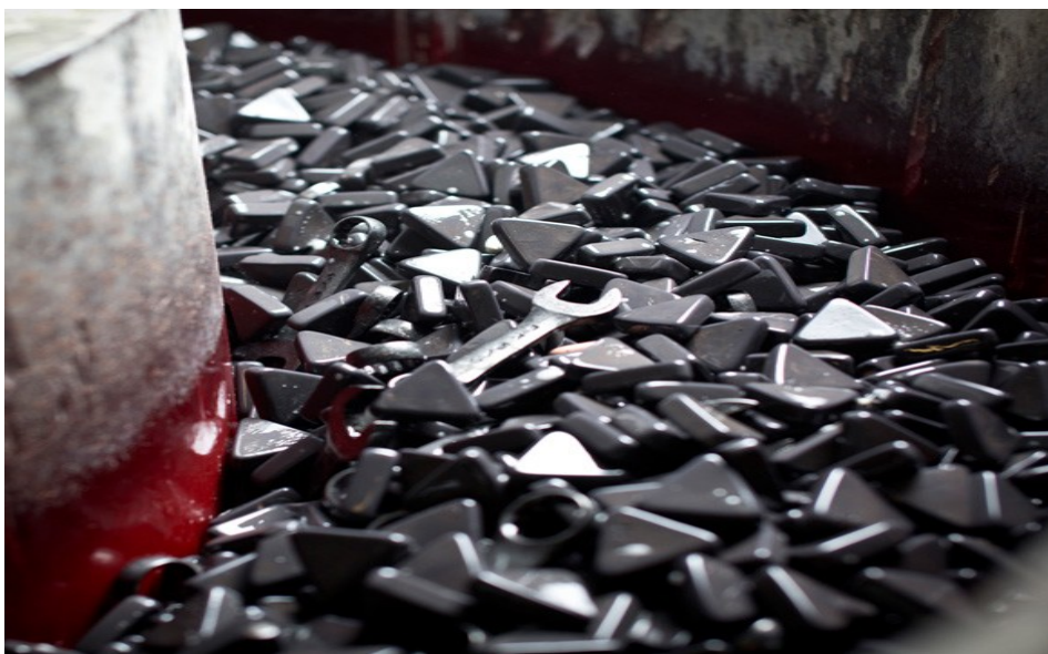
Obr. 9. Omílání výrobků v horizontálním bubnu [10]
