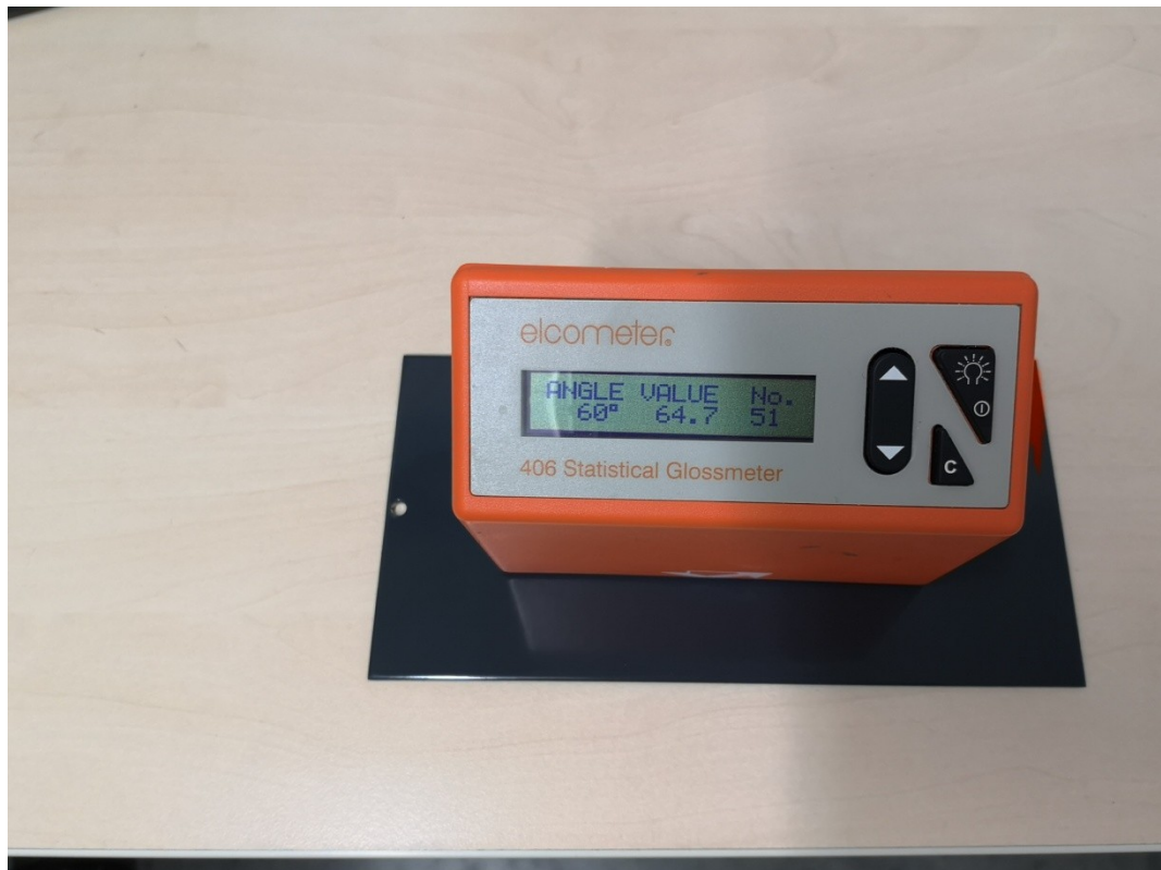
Obr. 37. Příklad měření lesku na zkušebním vzorku
