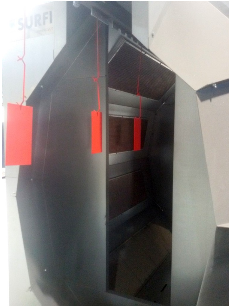
Obr. 30. Průjezd nalakovaných vzorků infračervenou pecí
