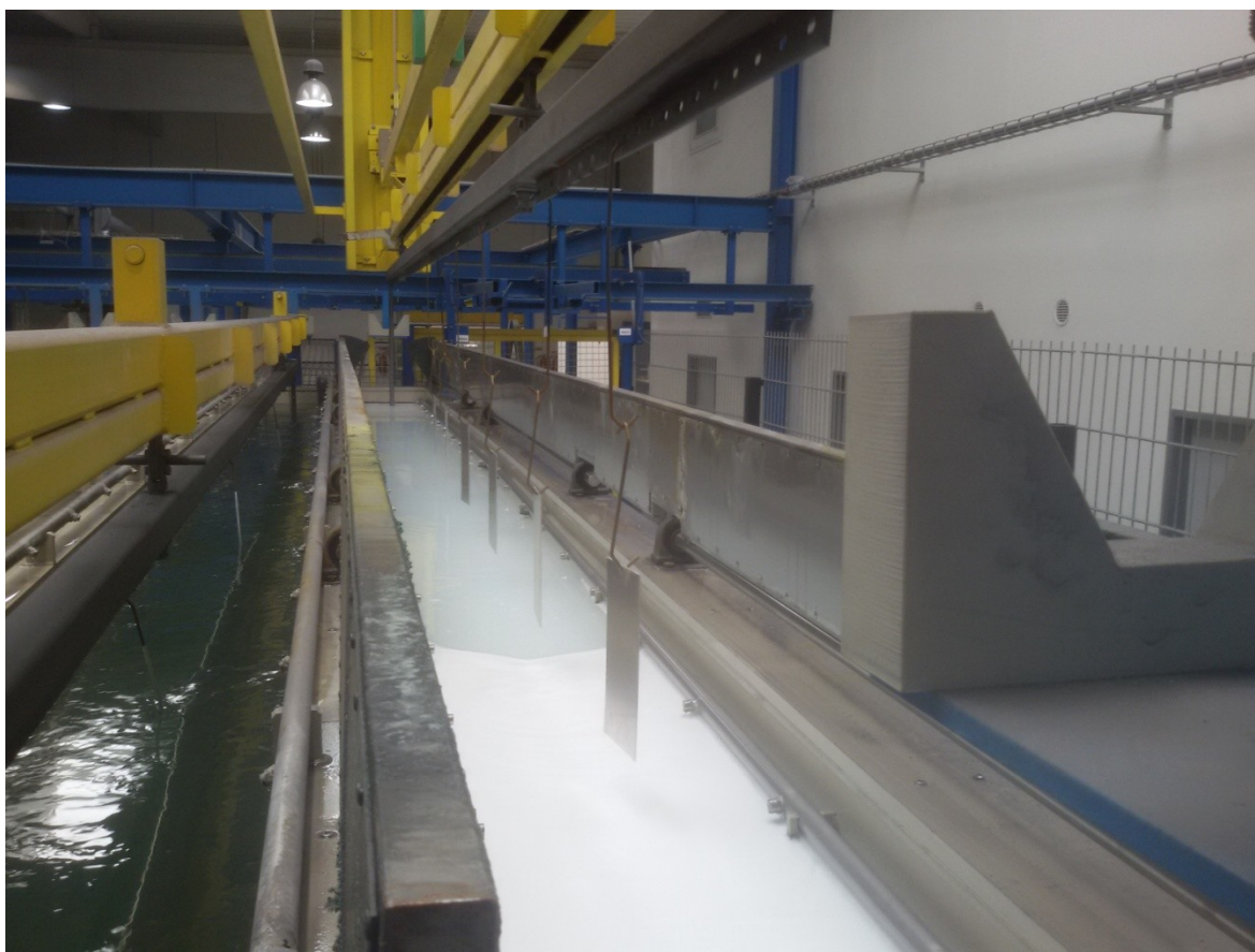
Obr. 26. První operace chemické předúpravy – deoxidace a odmaštění vzorků
