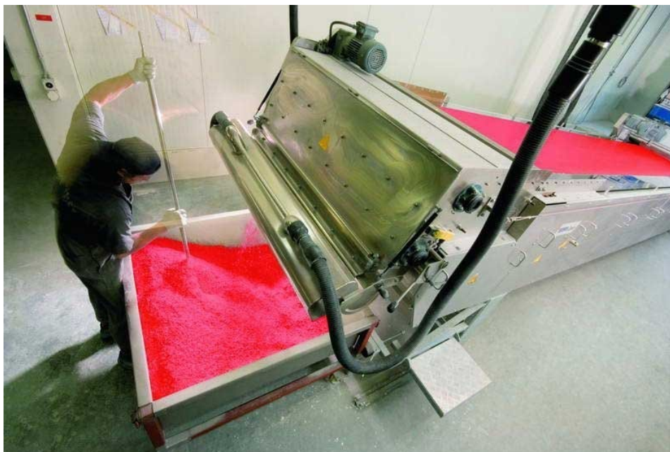
Obr. 15. Rozválcování a drcení práškového plastu [21]
