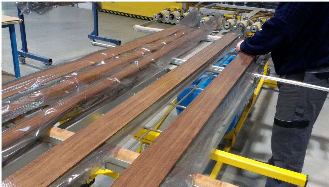
Obr. 12 Nanesení dekoru dřeva na hliníkové profily
