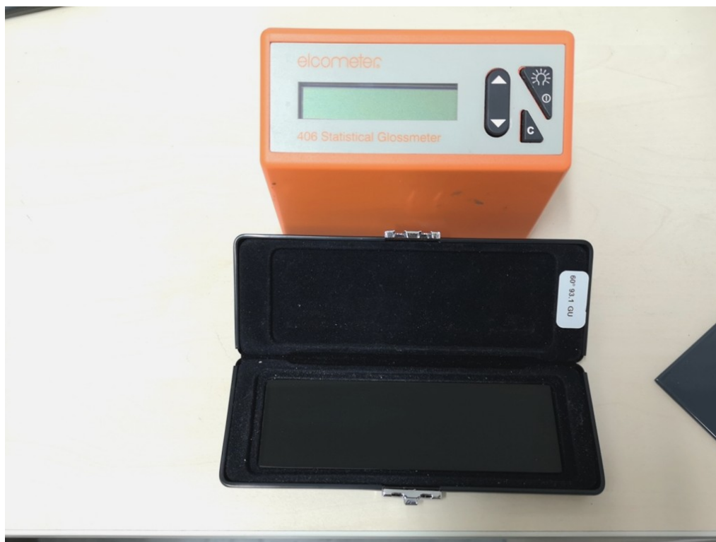
Obr. 36. Použitý měřicí přístroj s kalibrační černou destičkou
