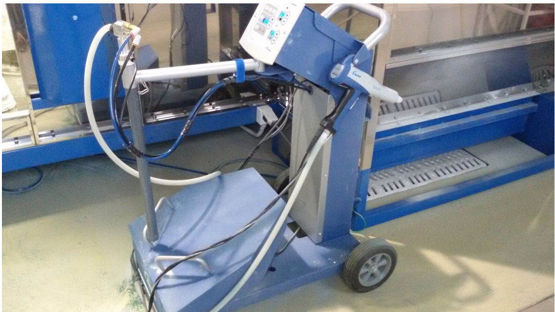
Obr. 17. Aplikační zařízení s nanášecí pistolí
