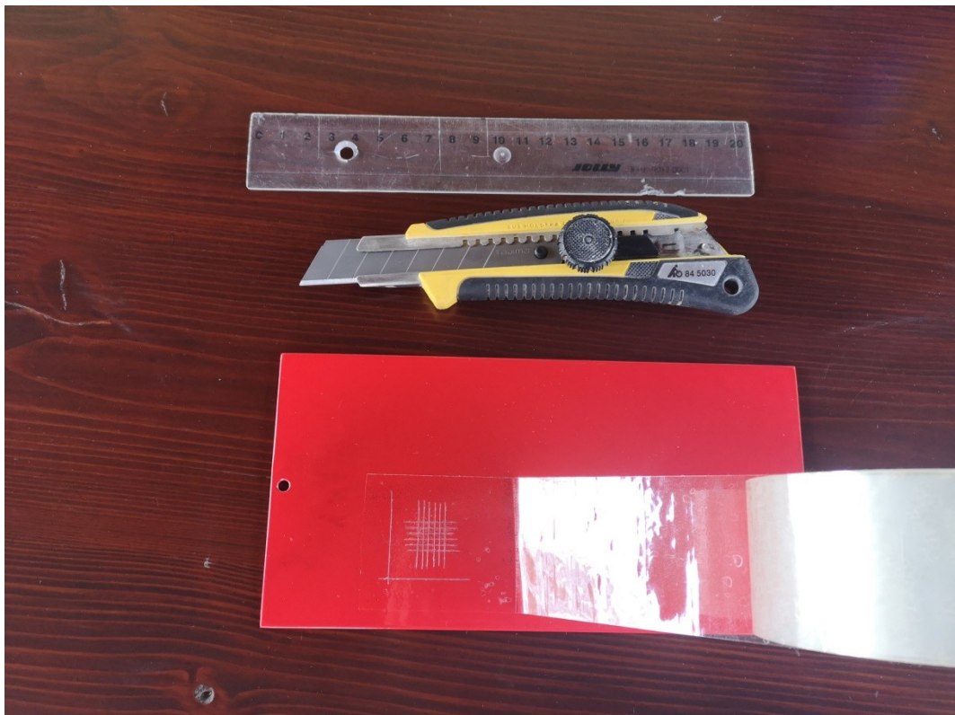
Obr. 34. Praktické provedení mřížkové zkoušky
