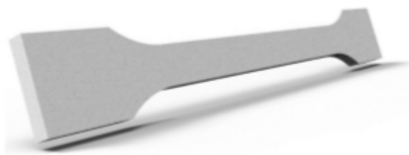
Obrázek 18. Zkušební těleso pro tahovou zkoušku [21]
