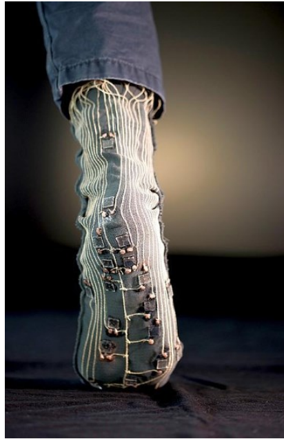
Obr.č. 16 Magnetoreologické elastomery jako snímače tlaku zabudované v ponožkách [20]
