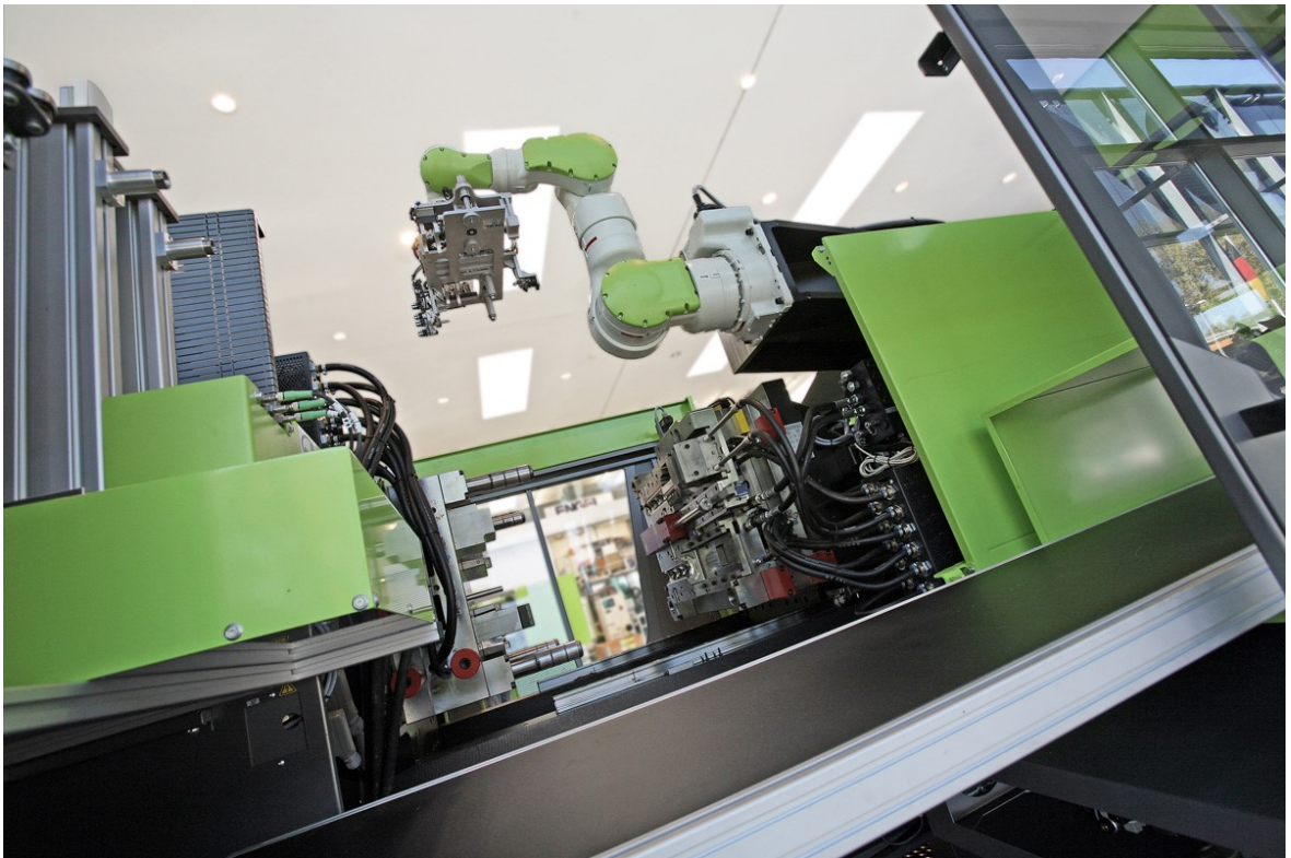
Obr. 15 Šestiosý robot Kuka integrovaný do řízení Engel [15]
