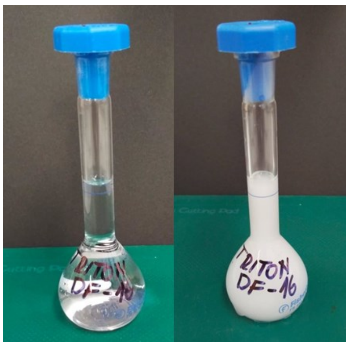
Obr. 7 Bod zákalu pro Triton™ DF-16 (36 °C)
