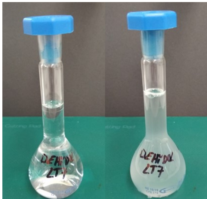
Obr. 6 Bod zákalu pro Dehydol® LT7 (55 °C)
