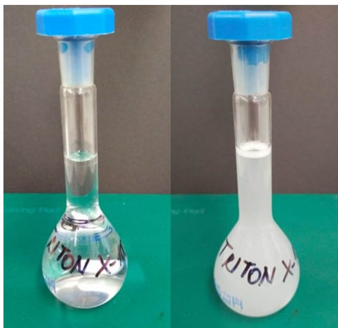
Obr. 5 Bod zákalu pro Triton™ X-100 (66 °C)
